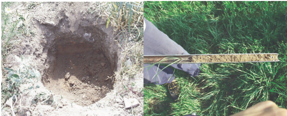
Abbildung 6: Links: Oberflächenabdeckung am Standort EI, erkundet mit Spaten und Krampen. Rechts: Oberflächenabdeckung am Standort OH, erkundet mit dem Bodenbohrer, entnommen dem Abschlussbericht EVAPASSOLD Phasen I-III [NÖ Landesakademie 2005]
