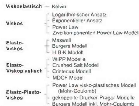
Abbildung 12: Einteilung der Langzeitverhaltens bzw. Kriechgesetze; a.) nach theoretischen und empirischen Modellen; b.) nach dem Materialverhalten
