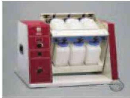
Abbildung IV-48: Darstellung eines Überkopfschüttlers [186]
