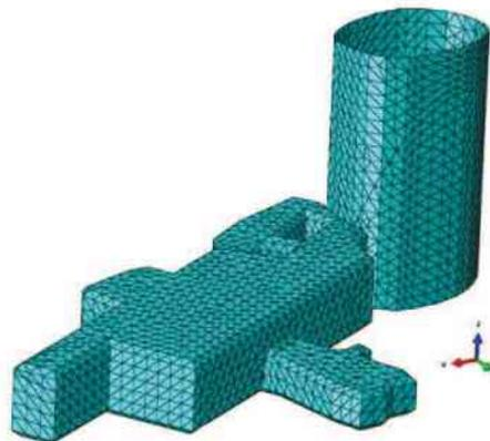
*Abbildung VI-12: Vernetzung des Festsaals inkl. Schacht mit Shell-Elementen;*
