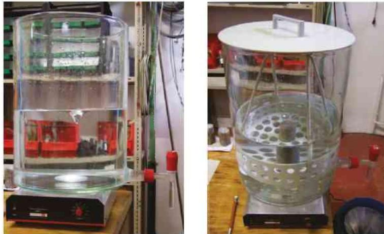
Abbildung IV-52: Versuchsaufbau Eluation; modifiziertes Trogverfahren
