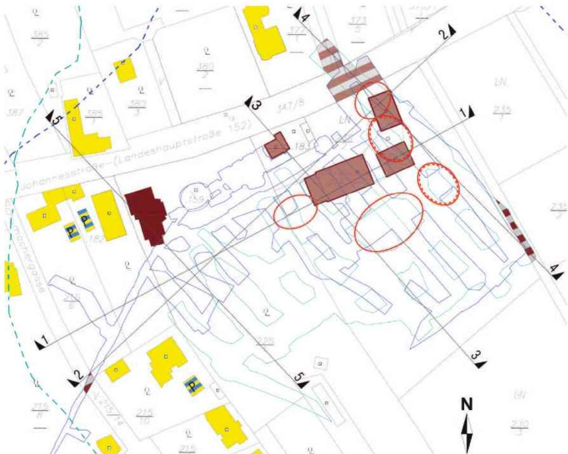
*Abbildung VII-6: Darstellung der Ergebnisse aus Analytik und Numerik zur Beurteilung der Langzeitstabilität des Grubengebäudes - Übersicht der kritischen Stellen; rot-durchgehend = Bereiche der obere Sohle; rot-strichliert = Bereiche der untere Sohle*
