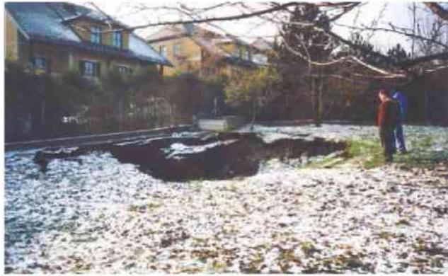
Abbildung II-7: Pingen in der Nähe eines Sickerschachtes im Bereich der Marienhöhe [31]
