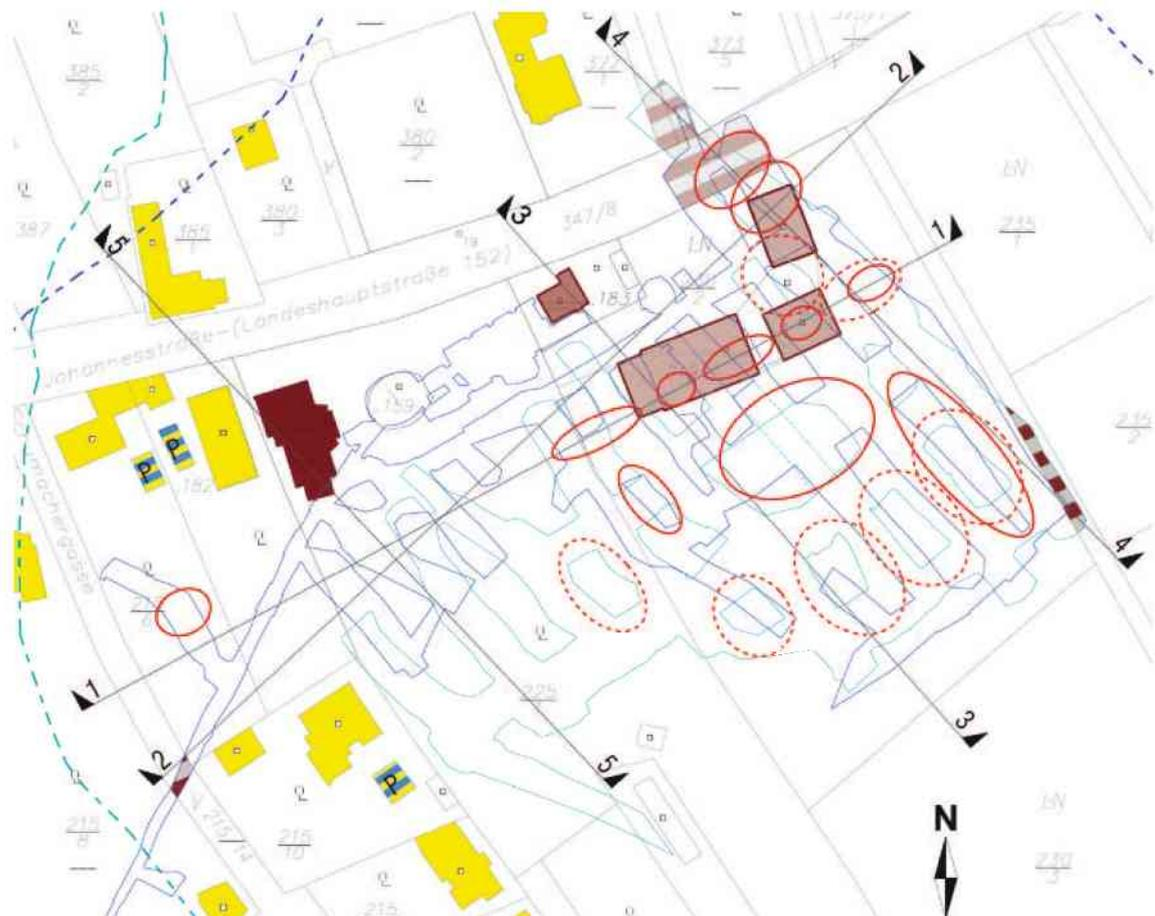
Abbildung VII-5: Darstellung der Ergebnisse aus Analytik und Numerik zur Beurteilung der Langzeitstabilität des Grubengebäudes - Übersicht der Bereiche mit Überbeanspruchung; rot-durchgehend = Bereiche der obere Sohle; rot-strichliert = Bereiche der untere Sohle
