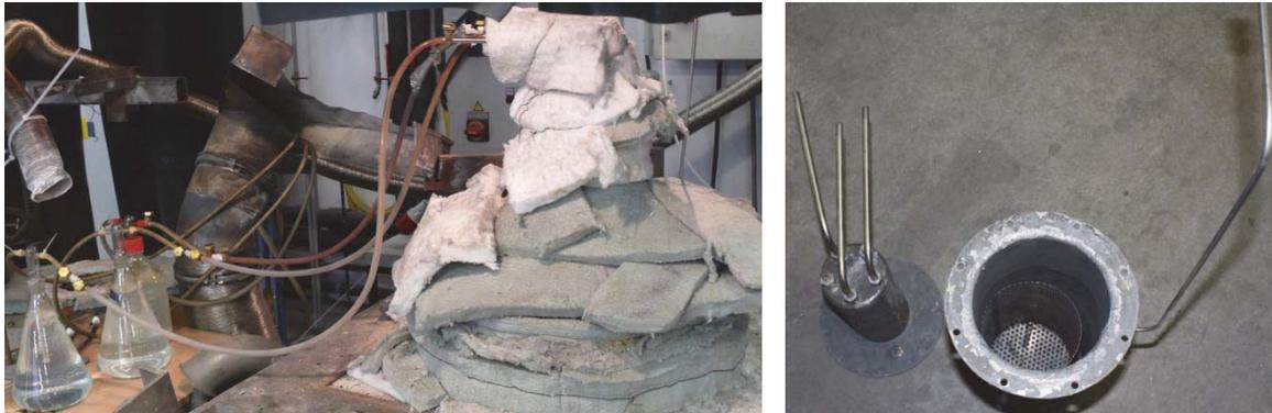
Abbildung 4-7: Aufbau der Tastversuche zur Pyrolyse mit integriertem Schmelzen
