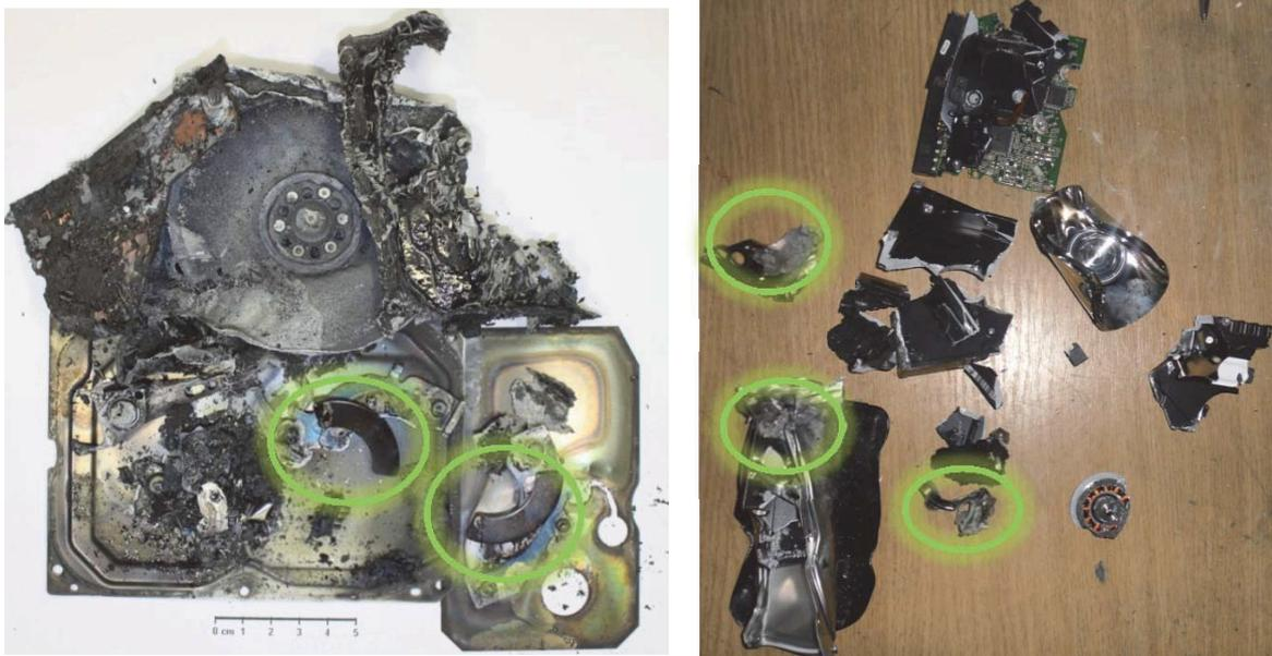
Abbildung 5-8: Vergleich der Versuchsergebnisse der Pyrolyse mit integriertem Schmelzen (links) und nach dem Stempelpressen (rechts), dabei hervorgehoben die Magnetfraktion
