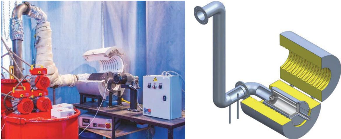
Abbildung 4-3: Pyrolyseofen, Antrieb und Getriebe des Retorteneinsatzes und 120 Liter fassendes Abgaswäschersystem (links), 3-D-Konstruktionszeichnung (rechts)
