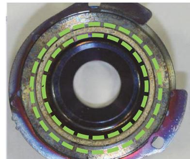
Spindelmagnet (zwischen der Markierung)
