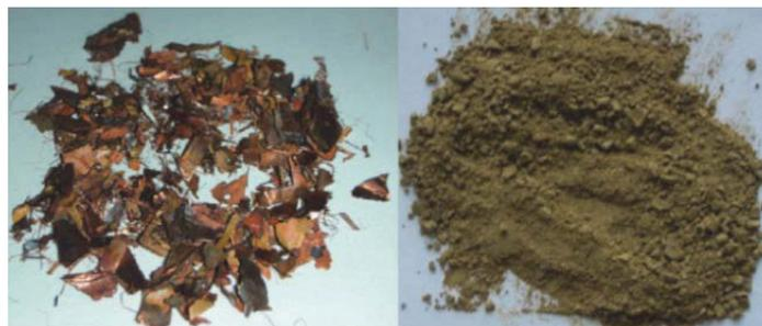
Abbildung 2-32: Produkte der Behandlung, Metallfraktion (links) und Pulver aus Kunststoff, Glasfaser und Epoxidharzabtrennung (rechts) [14]
