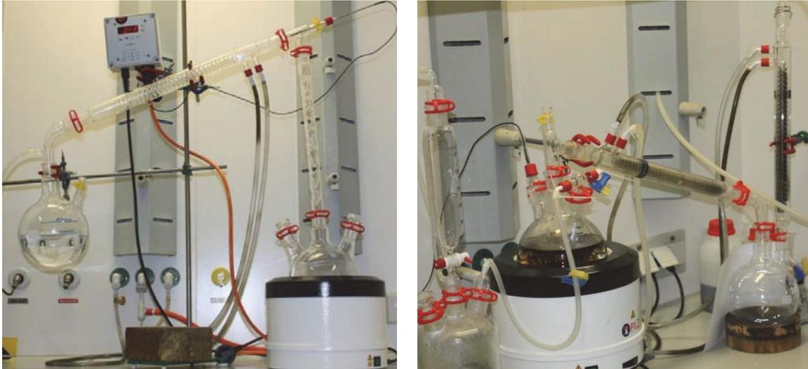
Abbildung 4-5: Versuchsaufbau zur Konzentrationssteigerung (links) und Br-Herstellung durch  $\text{Cl}_{(g)}$  (rechts)
