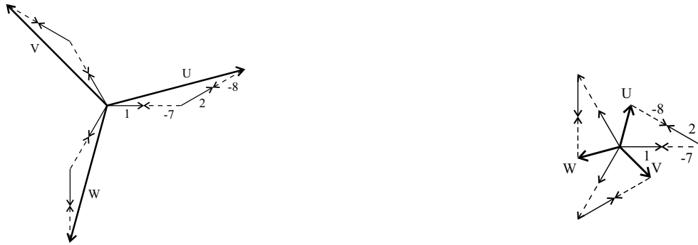
(a) Zeiger der induzierte Spannung für die Hauptwelle ( \nu = 1 )
