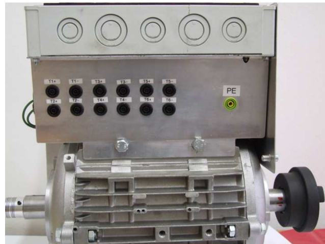
(b) Anschlussbuchsen der Temperaturmessung
