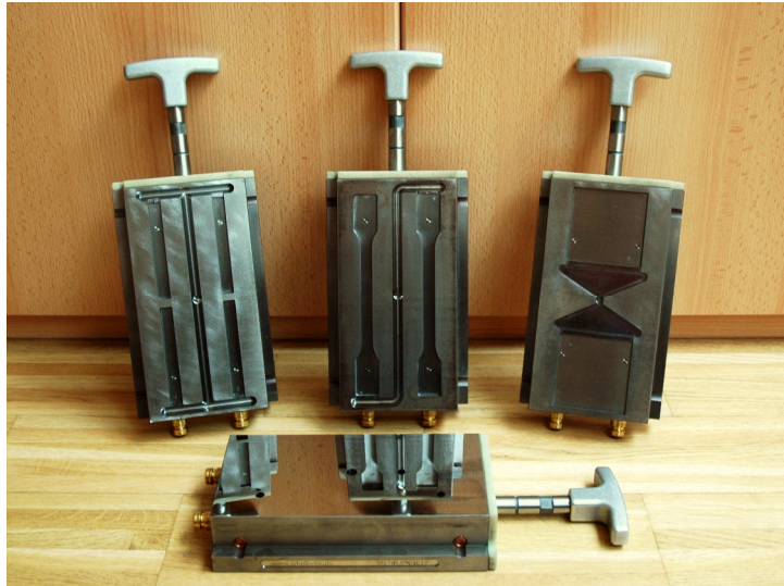
Abbildung 43: Schnellwechseleinsätze des Probekörperwerkzeugs
