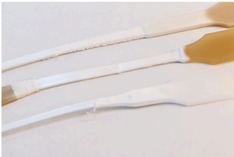
Abbildung 57: Bruchbild von geprüften verstärkten und unverstärkten Zugprüfkörpern aus PP DM55pharm
