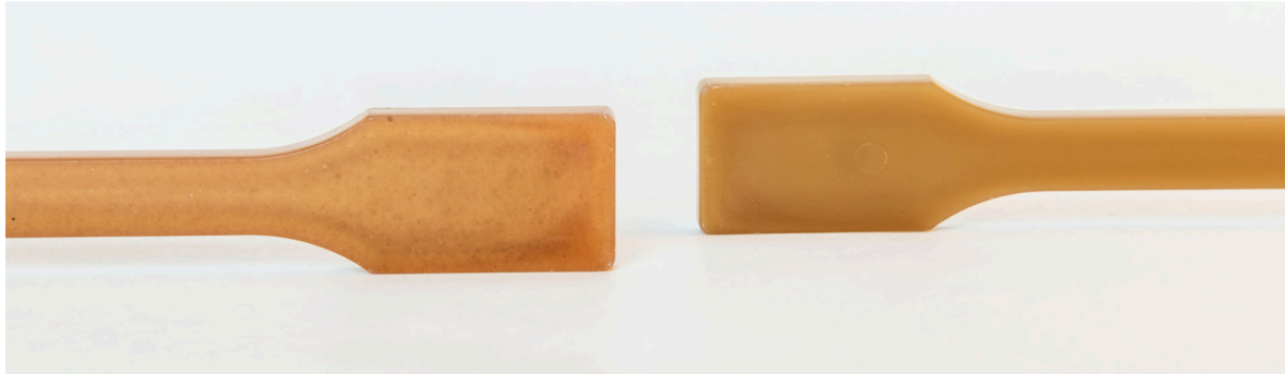
Abbildung 60: Füllstoffverteilung in Abhängigkeit von der Partikelgröße bei Glimmer; links MICA HLP 100 (größere Partikel), rechts MICA HLP 7 (kleiner Partikel); beide ohne Beschichtung
