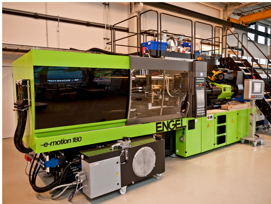
Abbildung 42: Engel Spritzgießmaschine e-motion 740/180T
