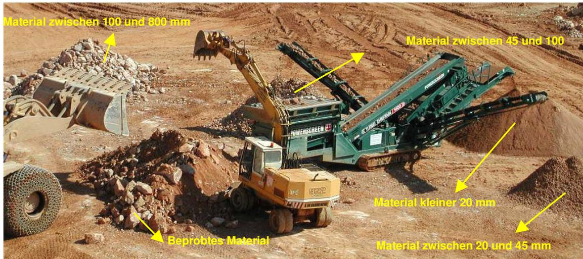
Abbildung 3. Absiebung der Großsprengung bei Cementos Portland
