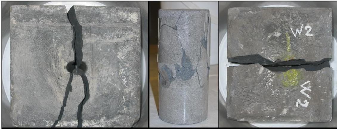
Abbildung 9. Quellzementversuche (a), Druckversuche (b) und Point-Load-Versuche an einem 200 mm-Würfel (c)
