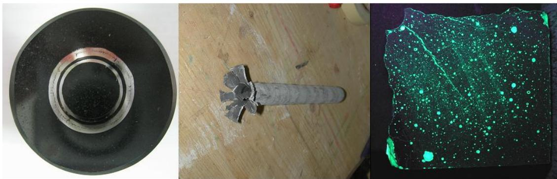
Abbildung 5. Stahlrohre im Anschliff (a), Stahlrohre nach der Sprengung (b), Visualisierung der Risse und Luftporen durch UV Licht im gesprengten Betonblock (c)
