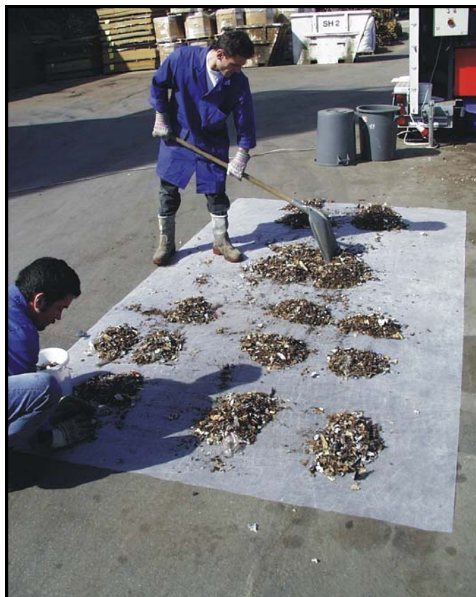
Abbildung B.2: Probenteilung mit Mischkreuzverfahren
