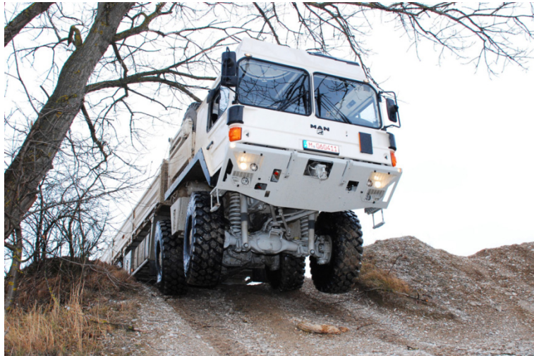
Abb. 5: Überlastszenario in der Sonderfahrzeugprüfung. Lenken auf der Kuppe während die erste Vorderachse in der Luft hängt [Quelle: MAN Nutzfahrzeuge AG]
