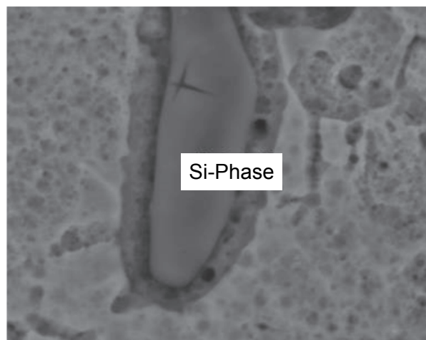
Abbildung 8-18: Angriff der Aluminiummatrix rund um eine hochsiliziumhaltige Phasen nach der Beizung in \text{HNO}_3 [91]
