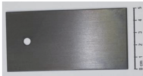
Abbildung 7-45: 6000-Legierung mit 80 \mu\text{m} dicker Eloxierschicht bereitgestellt bei Stromdichten von 5 \text{ A/dm}^2
