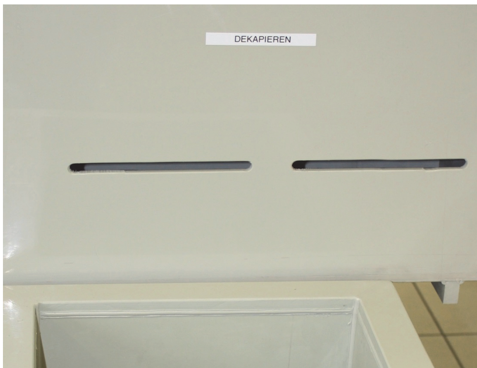
Abbildung 16-8: Öffnungen in der Absaugwand über dem Sealingbecken
