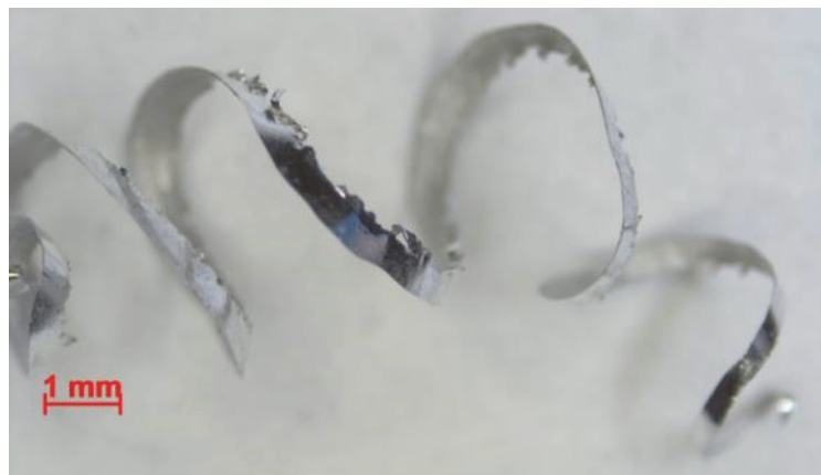
Abbildung 6-6: Span aus der 7075-Legierung nach der Diamantzerspanung ( D = 7000 , f = 3000 )
