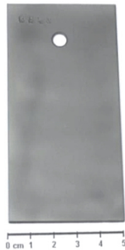
Abbildung 7-24: Rissfreie Probe nach dem Sealing bei einer Schichtdicke von 65 \mu\text{m} Schichtdicke, ermöglicht durch vorgeschaltetes Kugelstrahlen
