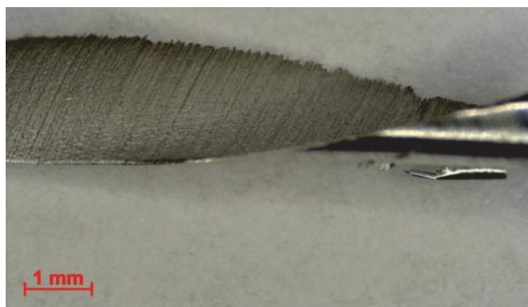
Abbildung 6-7: Sonderspan der Legierung 5083 mit sehr ebener Oberflächenstruktur
