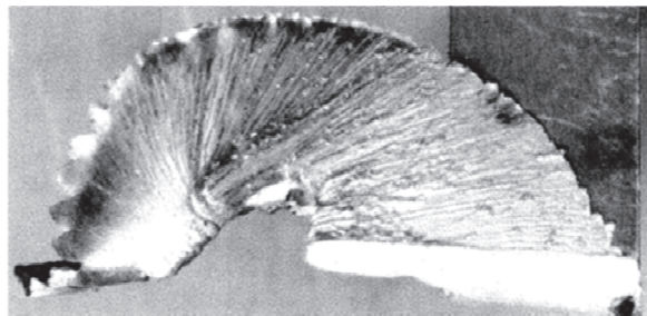
Abbildung 3-5: Scheinspan an einer Werkzeugfreikante nach der Zerspanung von Aluminium mit sehr hohen Geschwindigkeiten [30]
