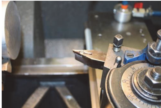
Abbildung 6-19: Darstellung der für die Versuche herangezogenen Hartmetallschneide und den entsprechenden Rundproben
