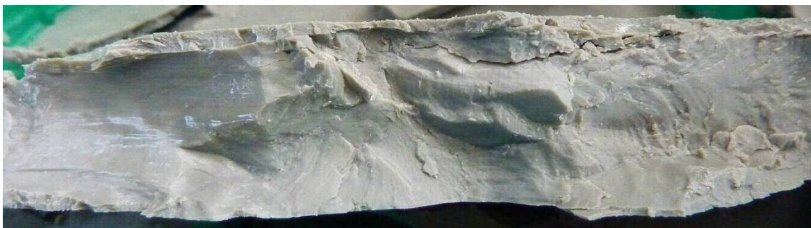
Abbildung 72: Filterkuchen aus der Filtration der Suspension des mit BDSACH organophil aktivierten Montmorillonites (Krischey, Ohrdorf, & Flachberger, 2015)
