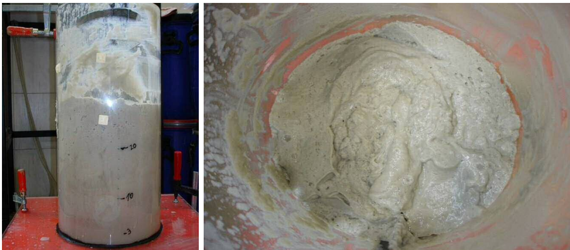
Abbildung 42 a und b: Organophile Aktivierung mit Ölsäure - Schaumbildung durch das bei der Verseifungsreaktion entstehende \text{CO}_2
