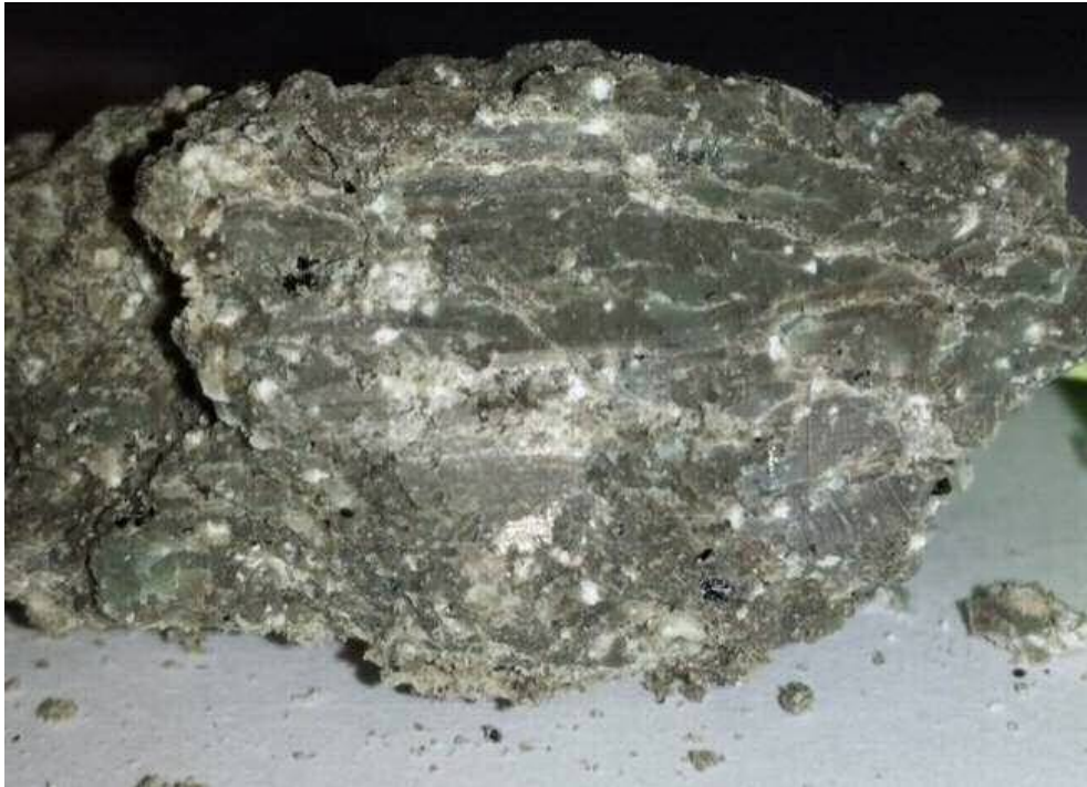
Abbildung 47: Rohbentonit mit erkennbaren Sedimentstrukturen
