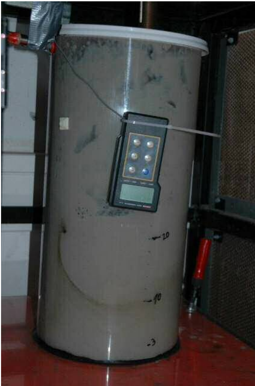
Abbildung 44: Abscheidung von Begleitmineralen an der Behälterwand, erkennbar als dunkles Band
