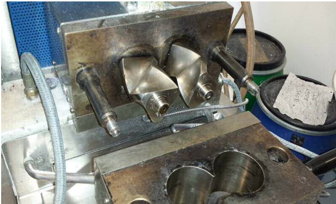
Abbildung 74: Knetkammer (Polylab System, Fa Thermo Scientific) am Lehrstuhl für Kunststoffverarbeitung
