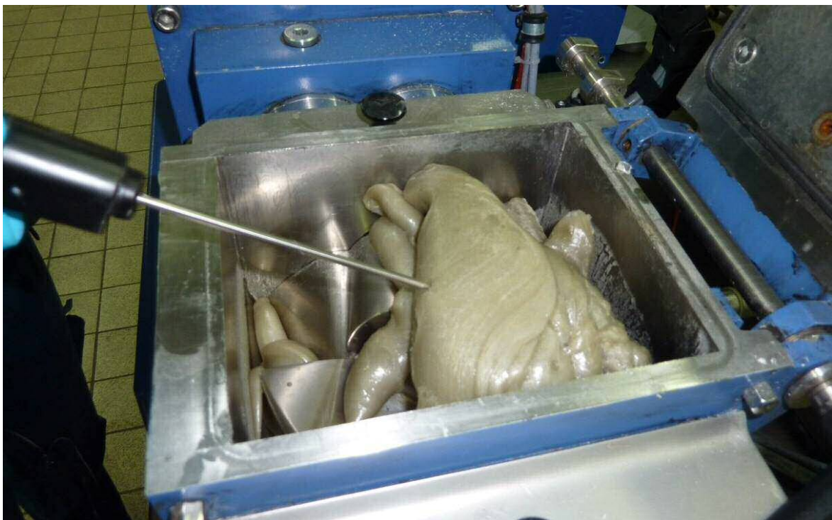
Abbildung 96: DUPLEX-Knetschaufeln und Messung der Mischguttemperatur
