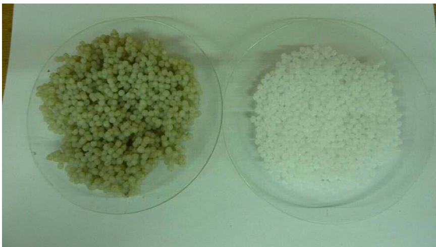
Abbildung 100: Manuell nach-homogenisierte Mischung aus DDAC+PP (li), reines PP Granulat (re)
