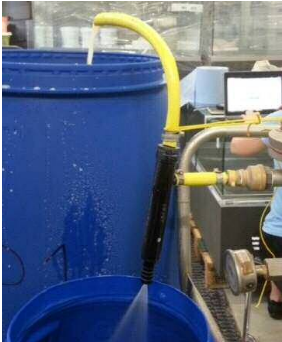
Abbildung 64: Hydrozyklon während der Ausreinigung der Bentonitsuspension mit gut erkennbarem, deutlich eingetrübten Überlaufvolumenstrom (~ 70 Vol-%) und Unterlaufvolumenstrom (~ 30 Vol-%)
