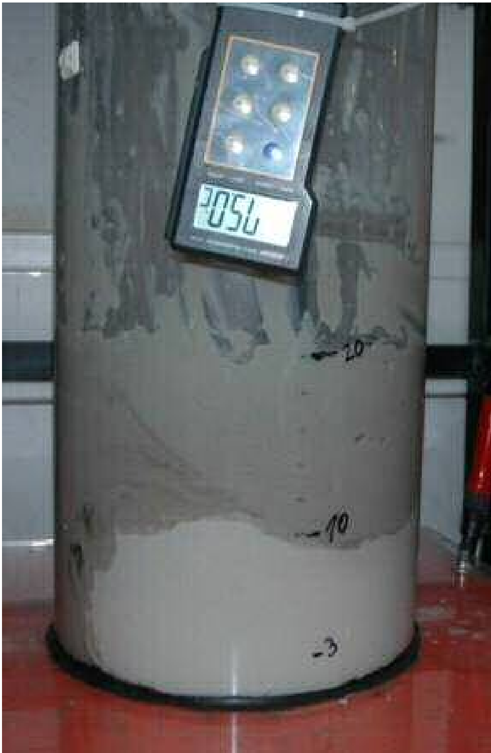
Abbildung 38: Zustand nach erfolgter partieller organophiler Aktivierung mit DDAC
