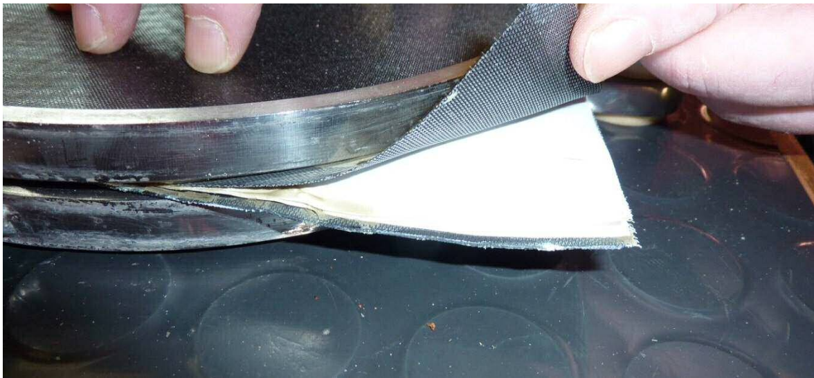
Abbildung 70: Zwischen den Filtertüchern eingelegtes Filterpapier in der Kammer
