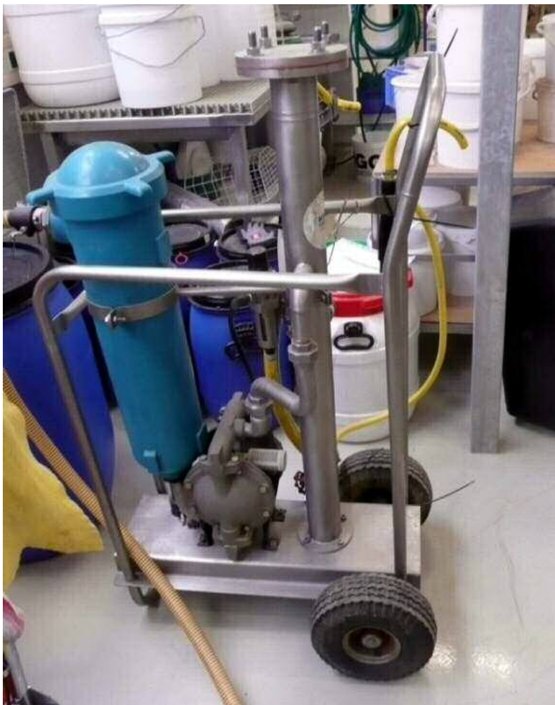
Abbildung 26: Mobiler Hydrozyklonstand der Fa. FLSmidth Krebs GmbH
