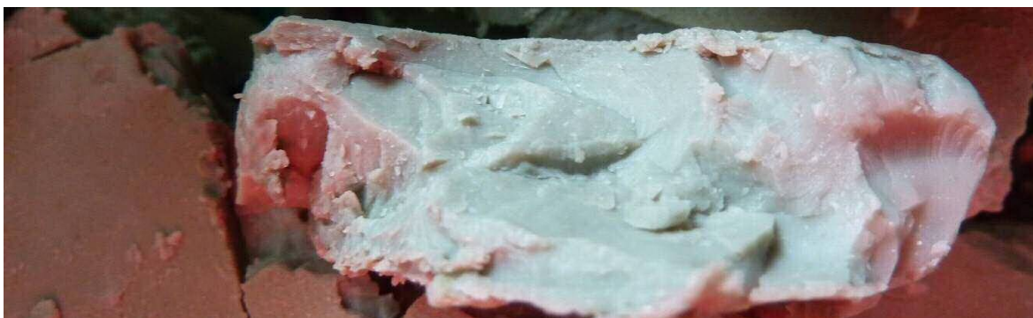
Abbildung 73: Filterkuchen aus der Filtration der Suspension des mit OA organophil aktivierten Montmorillonites
