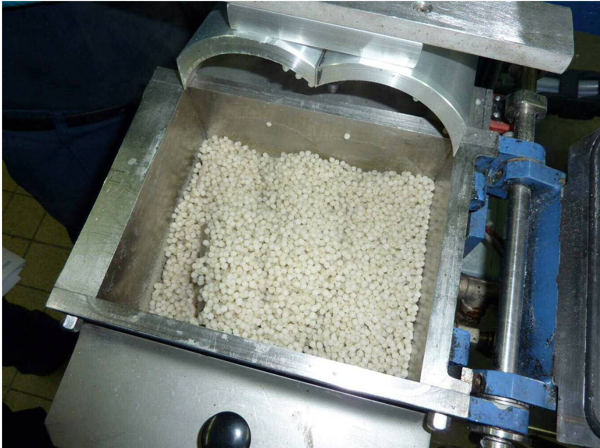
Abbildung 102: Offene Knetkammer mit kaltem Mischgut und Stempel
