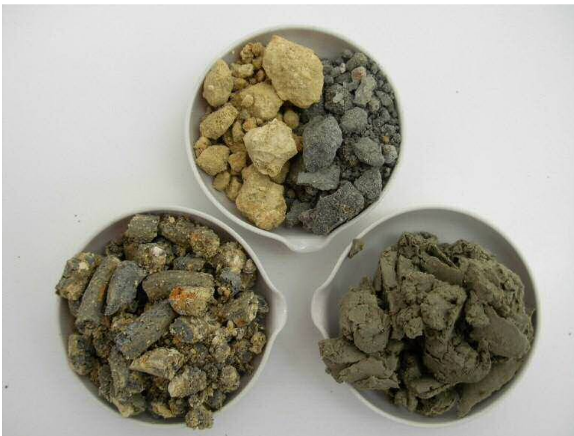
Abbildung 15: Homogenisierungsgrad unterschiedlicher Aktivierungstechniken; oben: Feldaktivierung unten links: Standardaktivierung Extruder unten rechts: I.B.O.-Technik (Ohrdorf, 2010, S. 55)
