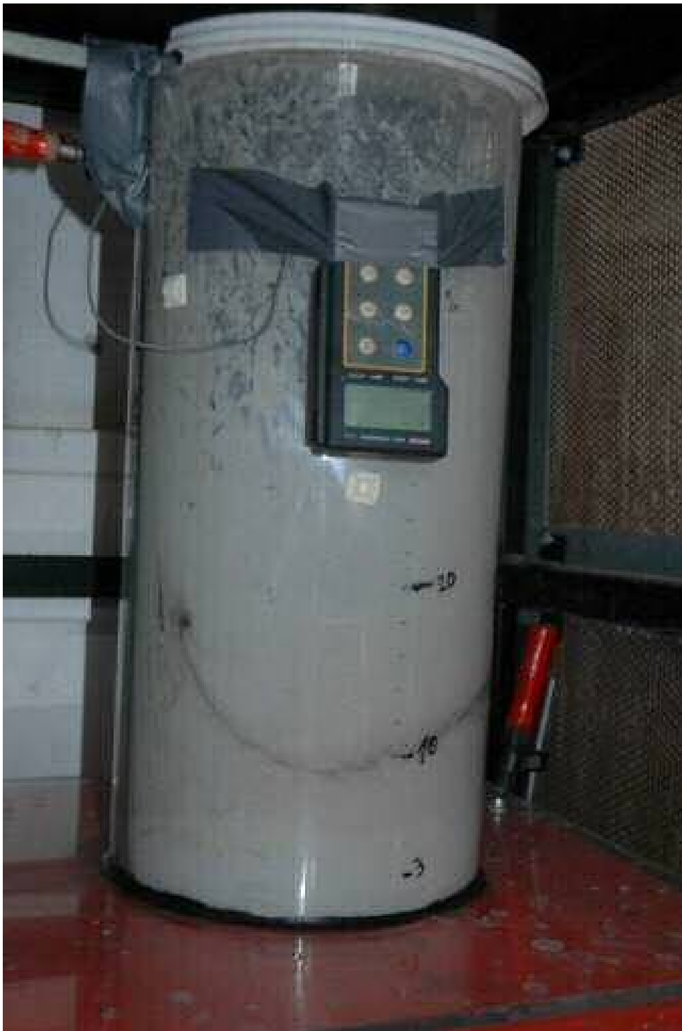
Abbildung 40: Umsetzung nach 60 minütiger Reaktionszeit, modifiziert mit BDSACH
