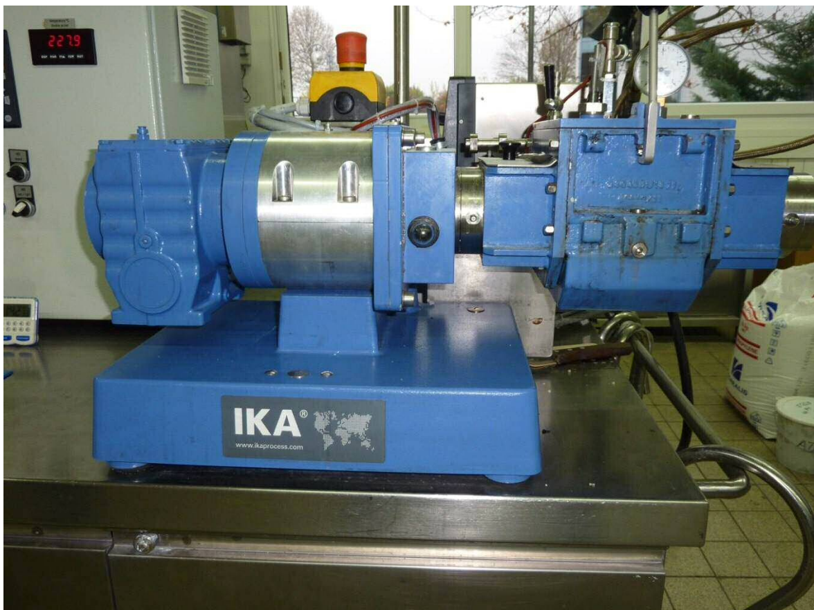
Abbildung 94: IKA HKD 2,5 - Doppelmuldenknetmaschine mit horizontal angeordneten Knetwellen
