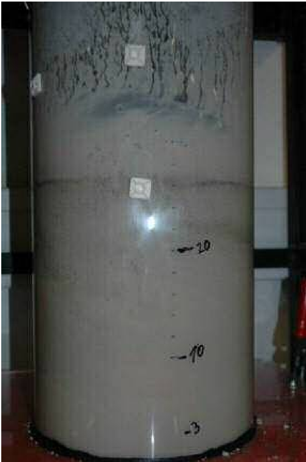
Abbildung 41: Umsetzung nach 60 minütiger Reaktionszeit modifiziert mit OA
