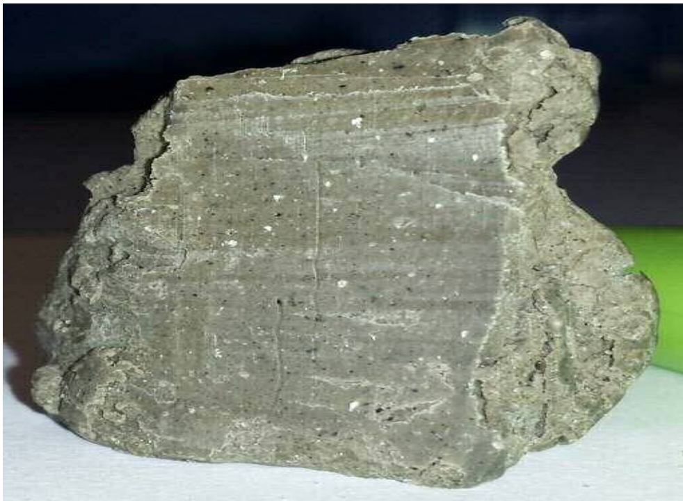
Abbildung 48: Alkalisch aktivierter Bentonit mit vollständig zerstörten Sedimentstrukturen
