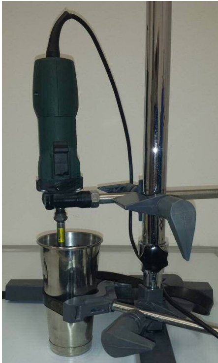
Abbildung 21: Labor-Rührwerk mit Rührbehälter gemäß API Spec. 13
