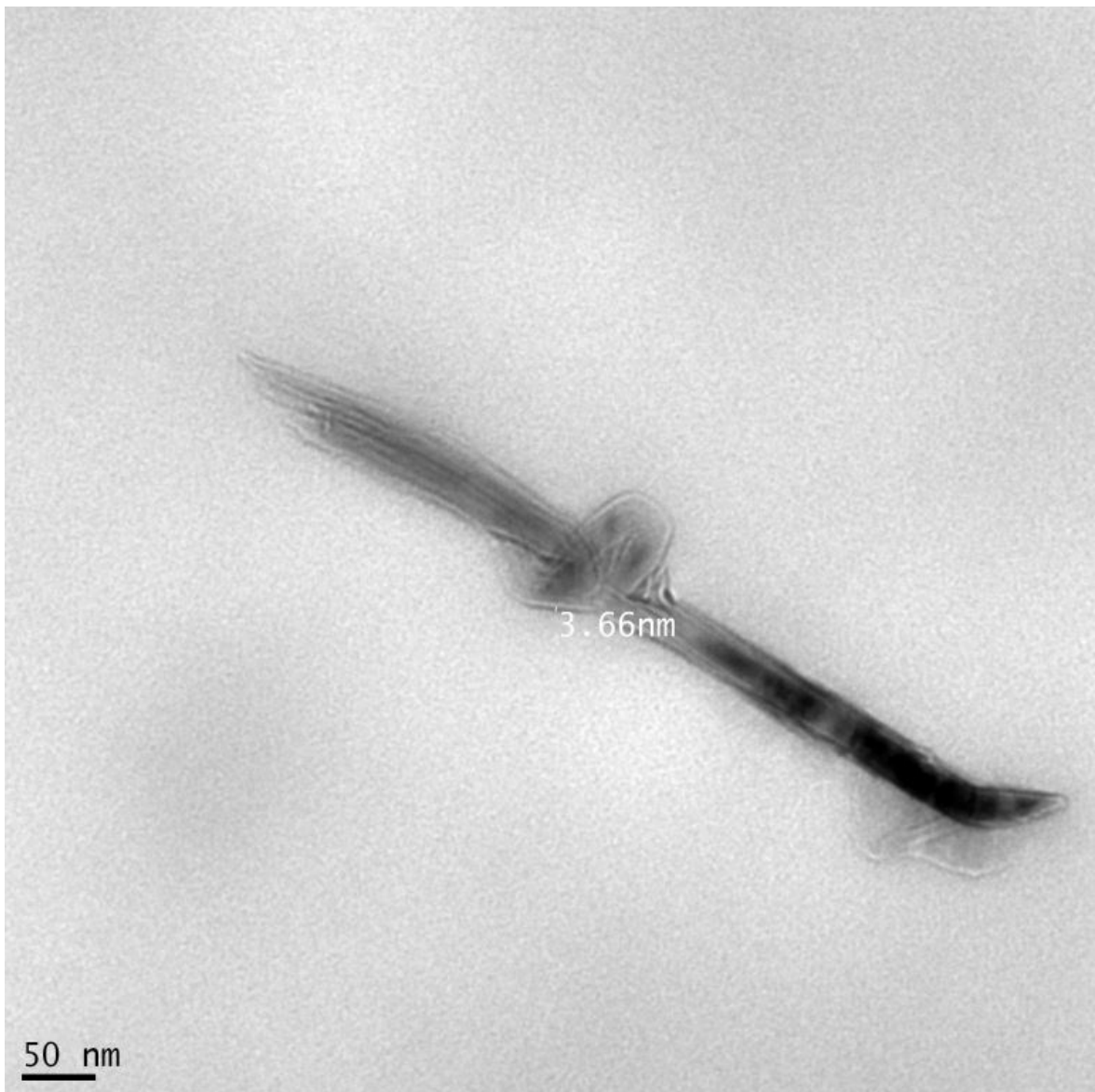
Abbildung 81: TEM-Aufnahme schräg angestellter Lamellen mit gemessener Schichtdicke
