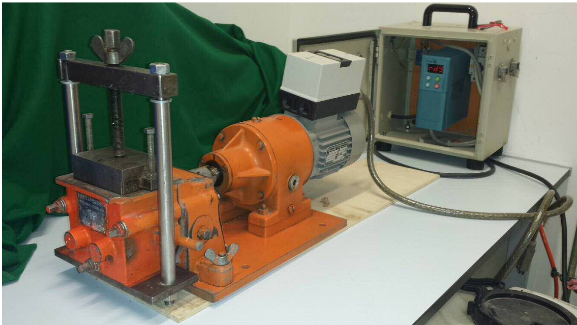
Abbildung 19: Von I.B.O. modifizierter Labor-Doppelwellen-Kneeter mit Z-Schaufeln, Fabrikat Werner & Pfeleiderer
