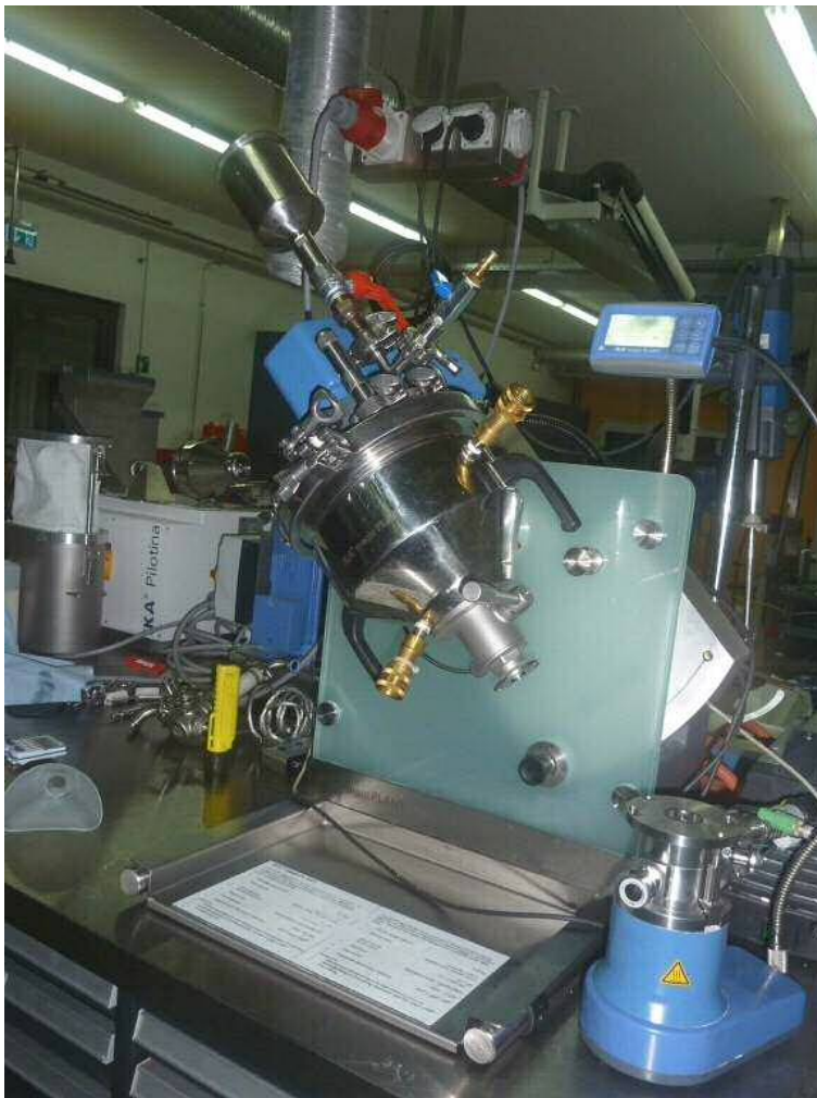
Abbildung 98: Spiralmischer Magic Plant, Fa. IKA
