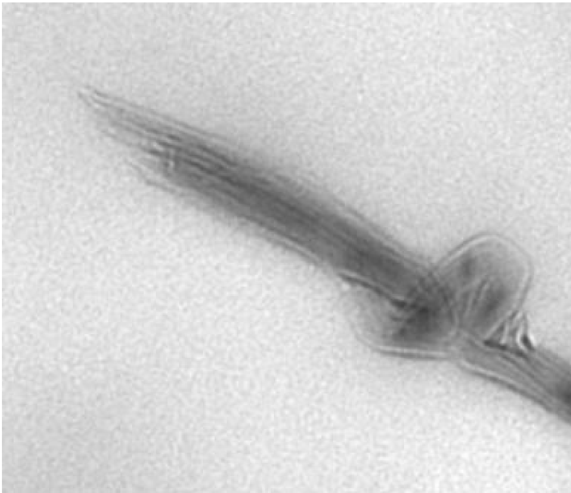
Abbildung 82: Vergrößerung der TEM-Aufnahme aus Abbildung 81, drei leicht schräg angestellte Lamellen
