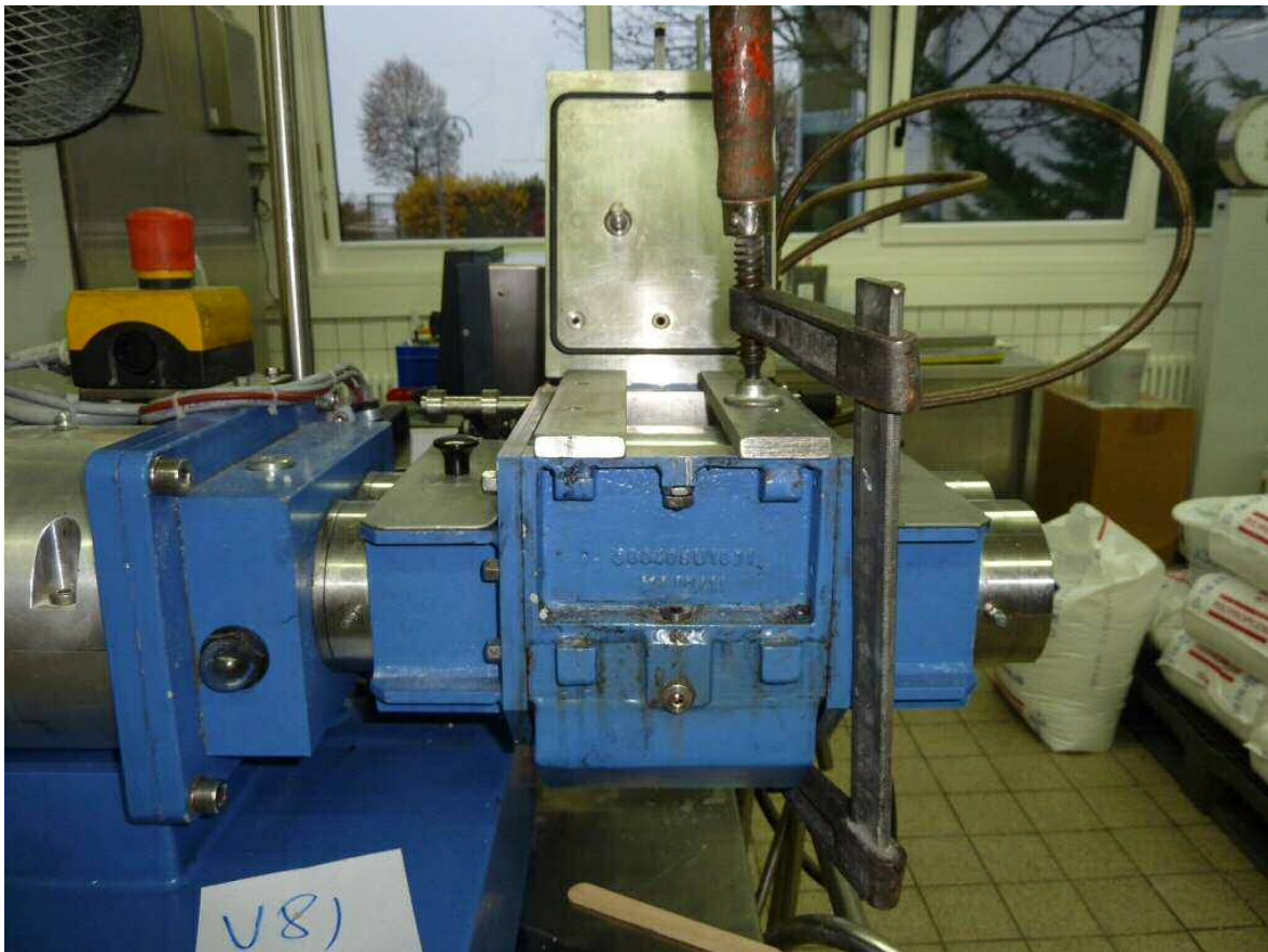
Abbildung 103: Geschlossene Knetkammer mit Stempel
