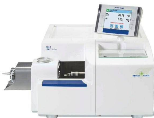
Abbildung 32: Thermogravimetrie Analysator von Mettler-Toledo (Quelle: http://www.directindustry.de )
