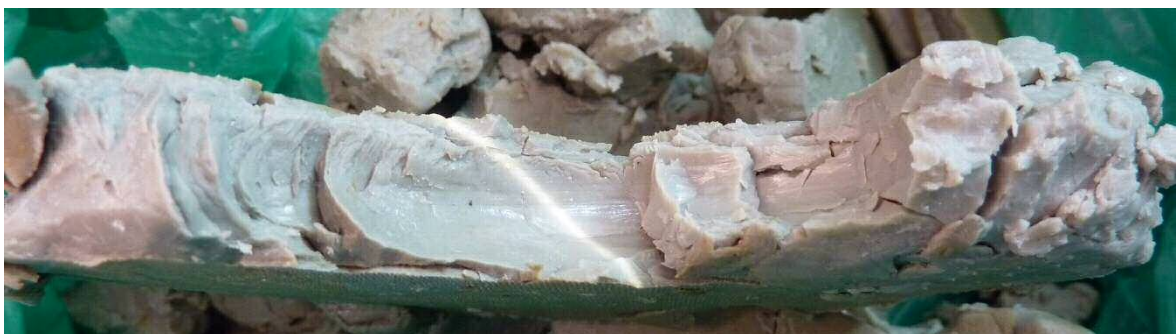
Abbildung 71: Filterkuchen aus der Filtration der Suspension des mit DDAC organophil aktivierten Montmorillonites
