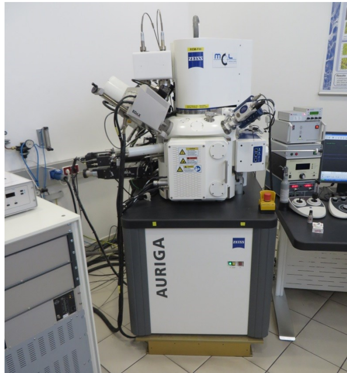
Fig. 38: SEM Auriga (Materials Center Leoben)
