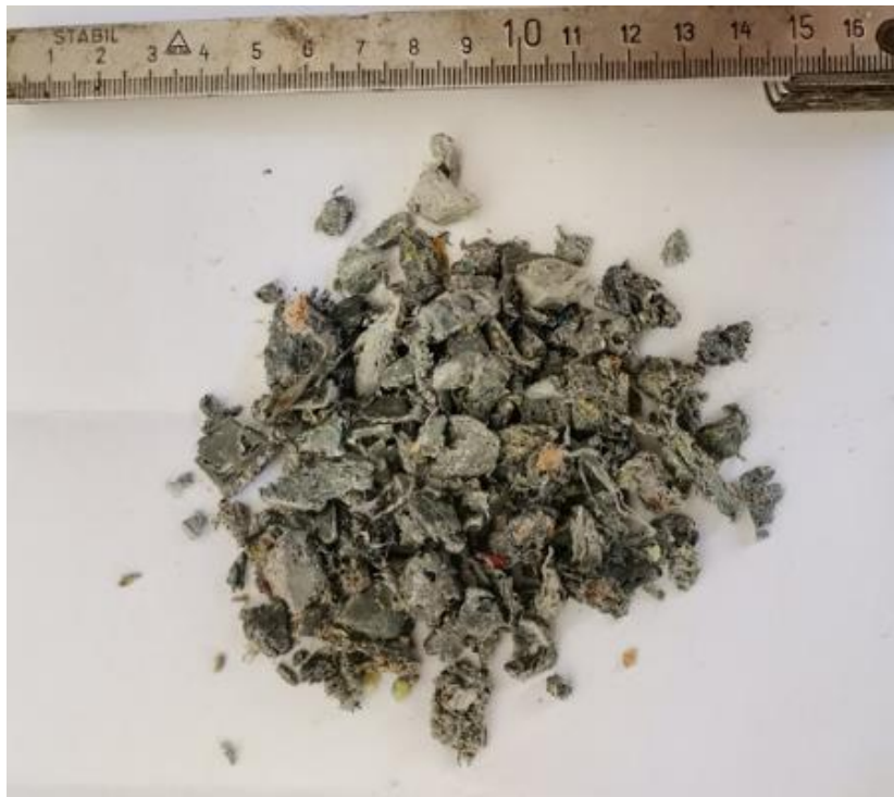
Abbildung 7: Agglomerat mit hohem Aufschmelzungsgrad
