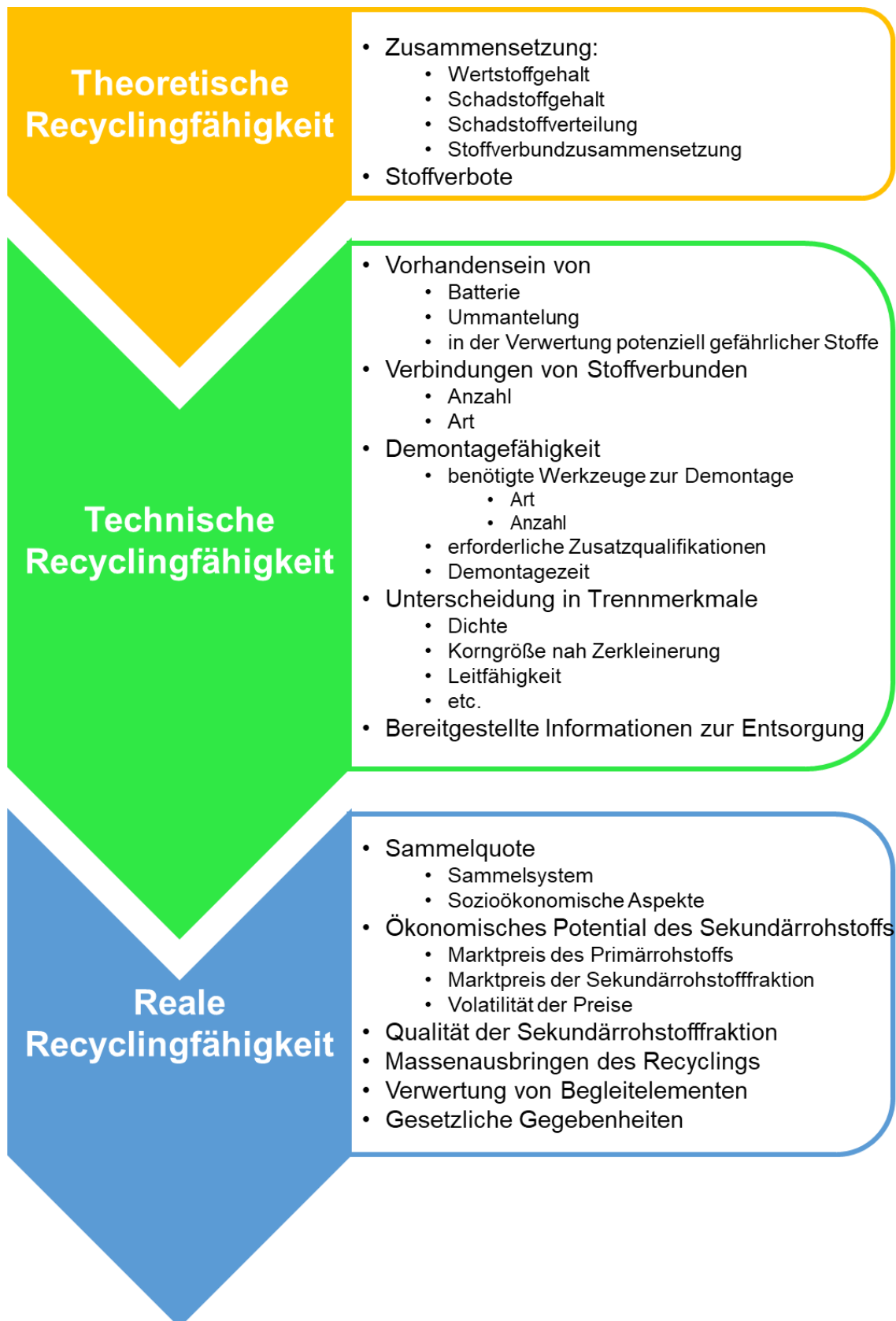
Abbildung 4: Faktoren der theoretischen, technischen und realen Recyclingfähigkeit
