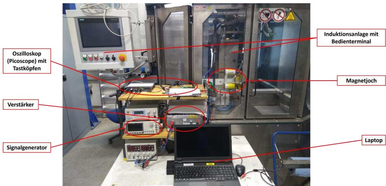
**Abb. 4-1:** Induktionsprüfstand
