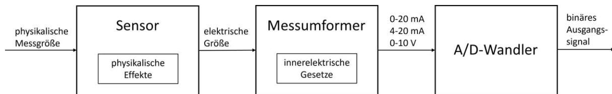
**Abb. 3-10:** Schematischer Ablauf der Umwandlung einer physikalischen Messgröße in ein digitales Signal (in Anlehnung an [25])
