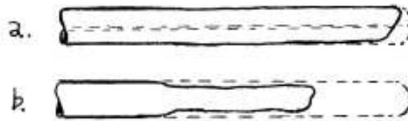
**Abbildung 2-7:** Elektroden nach Verwendung (a) mit Gas durch die Hohlkathode, (b) ohne Gas durch die Hohlkathode [26]
