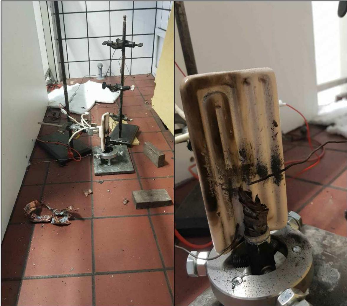
Abbildung 3.4.: Versuchsraum und LCO-Batterie nach der Explosion
