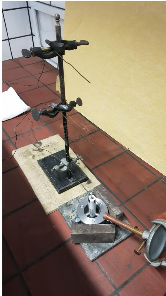
Abbildung 3.3.: Versuchsaufbau zum thermischen Durchgehen mittels Bunsenbrenner
