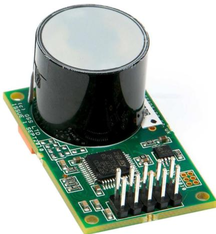
Abbildung 4.5.: Bild des CO<sub>2</sub>-Sensors mit dessen Entwicklerplatine [29]
