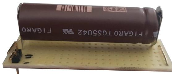
Abbildung 4.2.: Platine des CO Sensors
