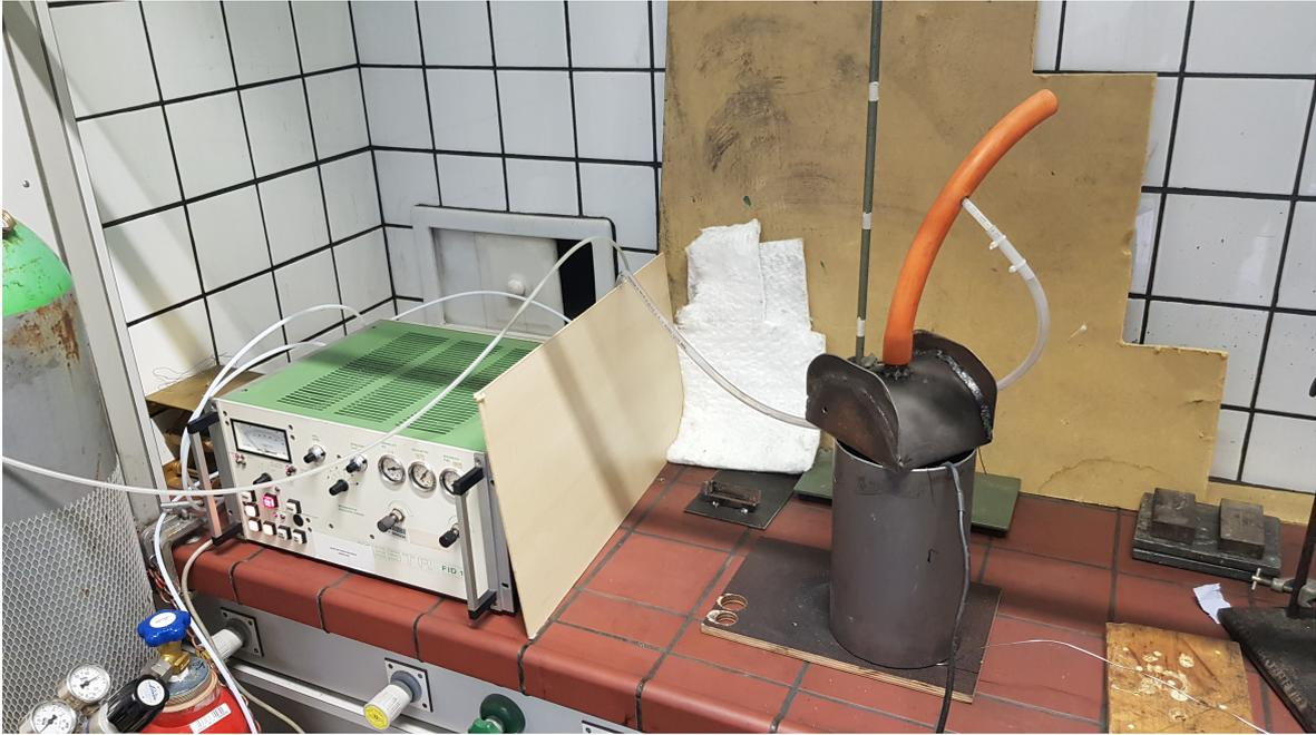
Abbildung 3.8.: Versuchsaufbau für die  $C_xH_y$ -Messung
