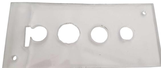
Abbildung 4.1.: Kunststoffplatte zur Platzierung der Sensoren
