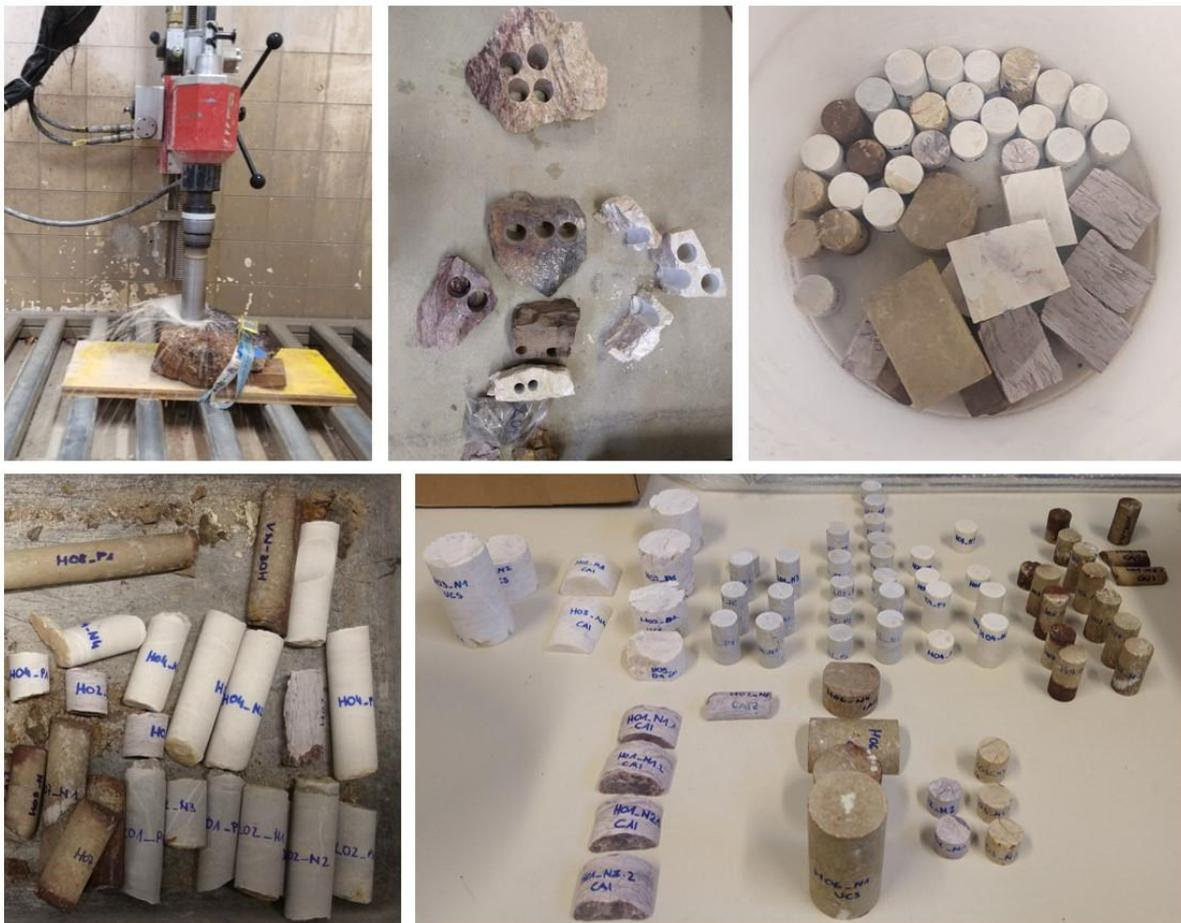
Abbildung 13: Der Weg vom Handstück zur prüffertigen Probe: Herausbohren der Gesteinsproben (Bild 1) und Übersicht über alle gefertigten Proben (Bild 2 bis Bild 4)
