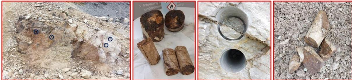
Abbildung 12: *Aufschluss c* – Entnommene Kernbohrungen (Bild 1) aus Zonen der Ankerite und Siderite (Bild 2) sowie Sauberger Kalke (Bild 3 und Bild 4)
