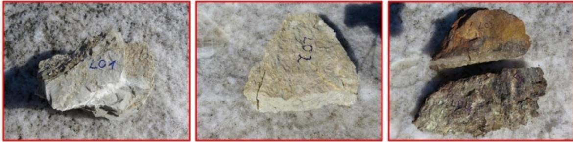
Abbildung 10: *Aufschluss c* – Sauberger Kalk (Handstücke L01, L02) mit gräulicher bis bräunlicher Gesteinsmatrix sowie Ankerit bzw. Siderit (Handstücke L03, L04) mit brauner Färbung
