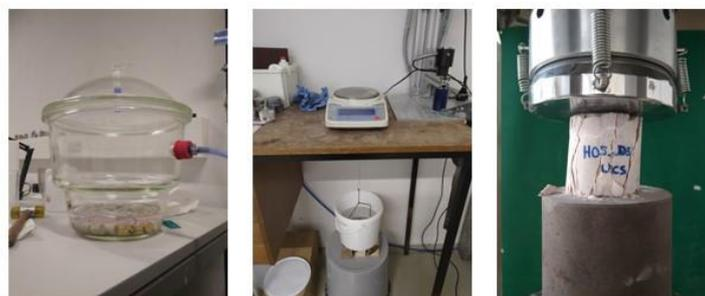
Abbildung 15: Tauchwägung und Bestimmung der einaxialen Druckfestigkeit
