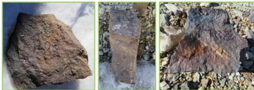
Abbildung 9: *Aufschluss b* – Ankerite bzw. Siderite (Handstücke H06, H07, H08) mit brauner bis dunkelbrauner Färbung
