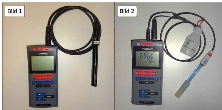
Abbildung 52. Verwendete Messgeräte - Bild 1: Leitfähigkeits-Messgerät Cond 3110 (WTW);
