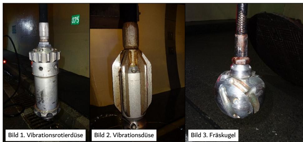
Abbildung 33. Verwendete Düsenköpfe während den Wartungsarbeiten; UT Grünburg
