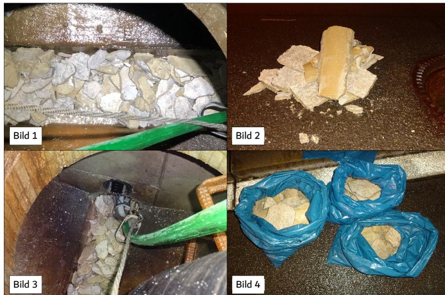
Abbildung 44. Bild 1-4: Abgelöste feste Versinterungen aus der Transportleitung; Tunnel Reinertshof
