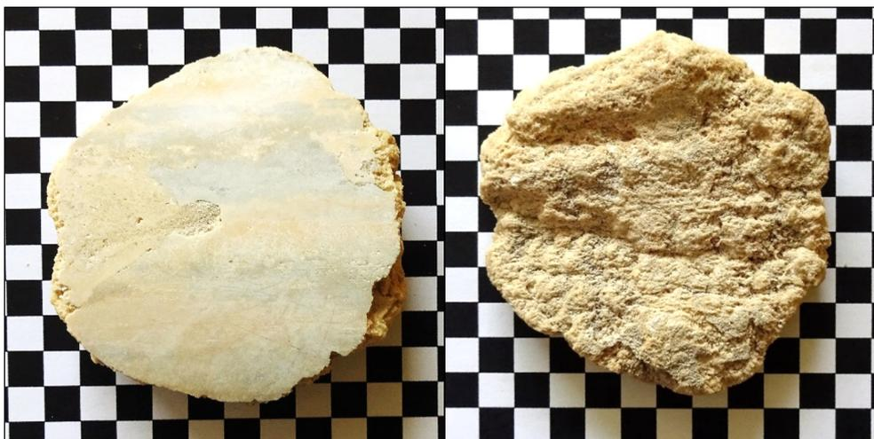
Abbildung 23. Abgelöste Versinterungsprobe aus der südlichen Ulmendrainage auf einem 1x1cm Raster; UT Hausmannstätten
