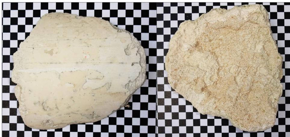
Abbildung 35. Abgelöste Versinterungsprobe aus Ulmendrainage auf einem 1x1cm Raster; UT Grünburg
