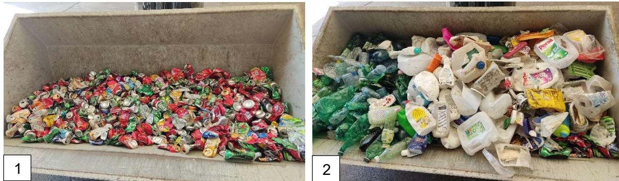
Abbildung 27: (1) Anteil NE-Metalle an der Mischung, (2) PET- (links), PE- (Mitte) und PP/PS- (rechts) Anteil an der Gesamtmischung.
