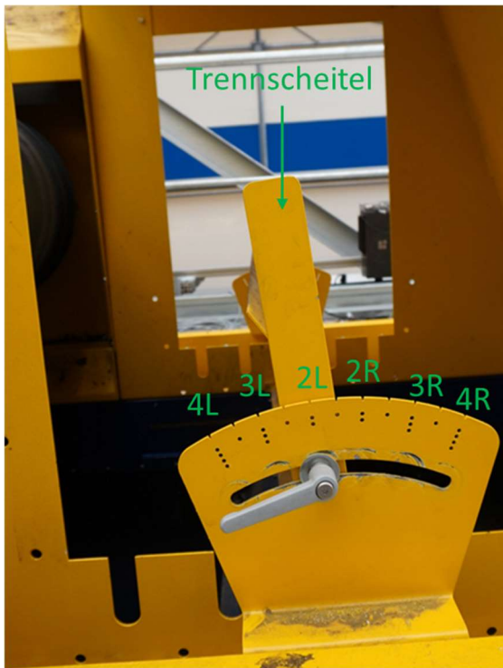
Abbildung 29: Einstellmöglichkeiten Trennscheitelwinkel (gewählte Position 2L).
