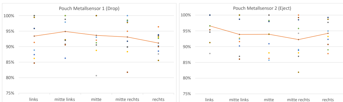
Abbildung 59: Verteilungen innerhalb einer Materialart am Beispiel Pouch bei Metallsensor 1 (links, Drop) und Metallsensor 2 (rechts, Eject). Der Mittelwert der Daten ist als Linie dargestellt.
