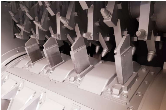
Abbildung 5: Sackaufreißer mit Aufreißrotor und Aufreißkamm (Matthiessen Lagertechnik GmbH 2022).
