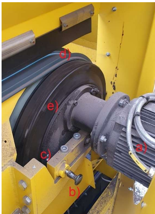
Abbildung 28: Einstellmöglichkeiten Polrad (aktuelle Lochposition mit Winkel 0°).
