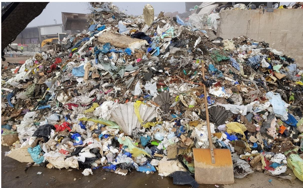
Abbildung 40: Ergebnis der Zerkleinerung mittels Komptech Terminator [Foto: Sandra Viczek]
