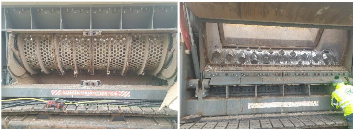
Abbildung 29: Lochsieb (links) und Schneidewerkzeug (rechts) im Detail
