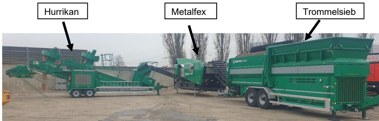
Abbildung 42: Versuchsanlage 2D/3D-Trennung mittels Komtechmaschinen
