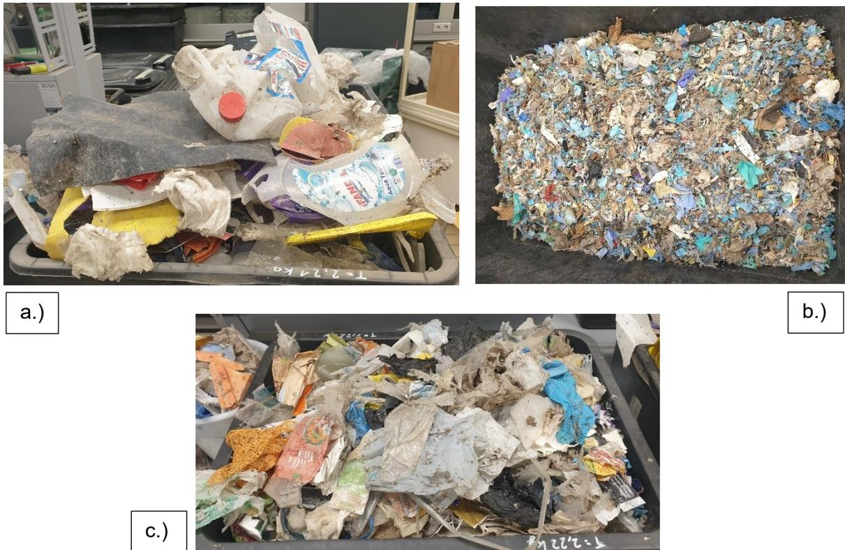
Abbildung 48: Ergebnis der manuellen Sortierung, a.) 3D-Material, b.) Rest, c.) 2D-Material
