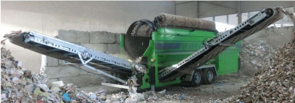
Abbildung 4: Trommelsieb der Firma Neuenhauser Maschinenbau GmbH [13]
