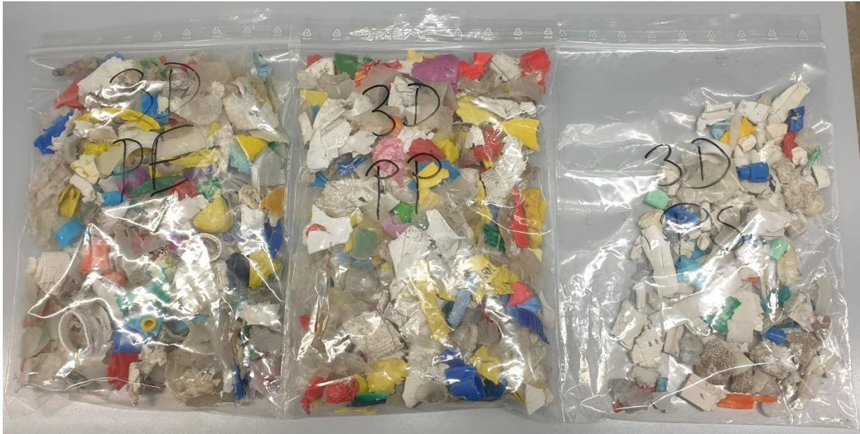
Abbildung 38: Menge der Kunststofffraktionen PE, PP, PS im 3D-Material dieser Anlage
