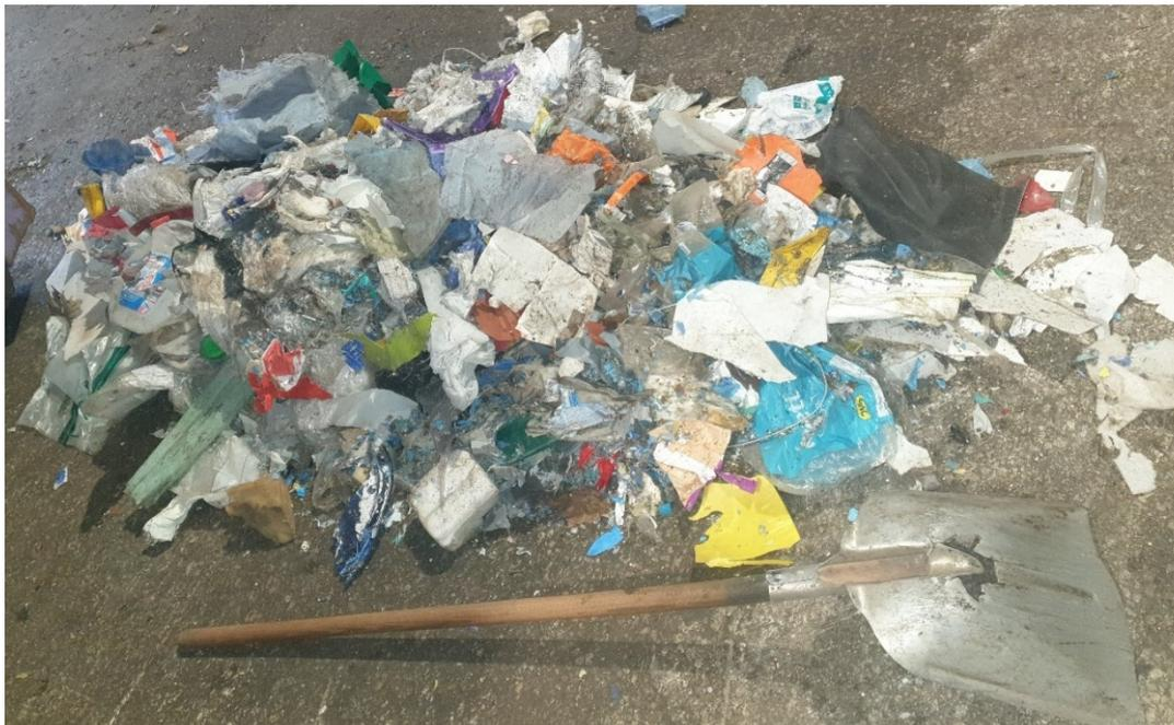
Abbildung 47: Ergebnis der PO-Sortierung mittels Redwave NIR
