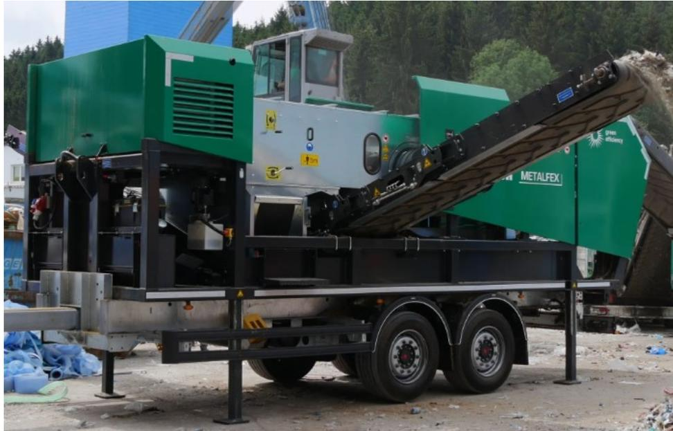
Abbildung 33: Metalfex Wirbelstromscheider der Firma Komptech GmbH [38]
