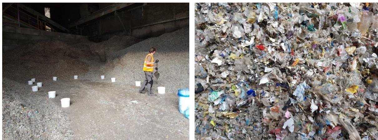
Abbildung 23: Probenahme (links) des 2D-Materials (rechts) [Foto: Sandra Viczek]
