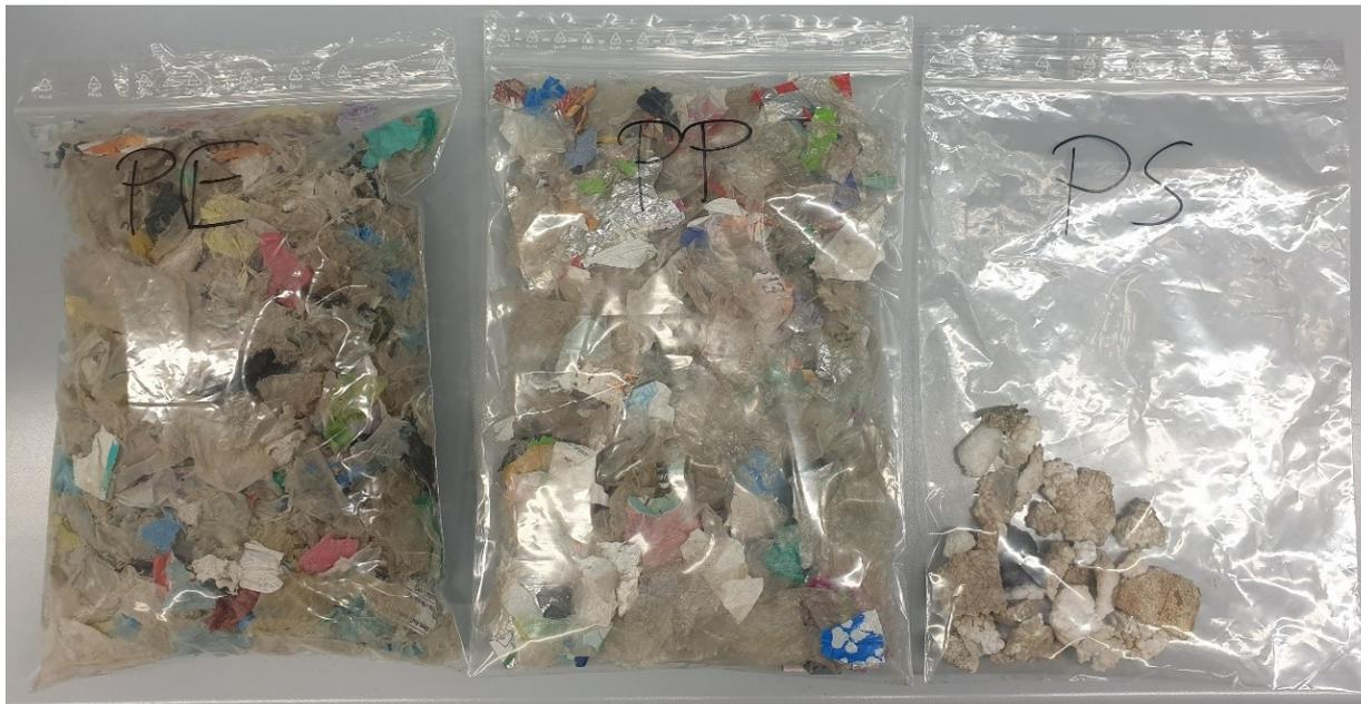
Abbildung 37: Menge der Kunststofffraktionen PE, PP, PS im 2D-Material dieser Anlage
