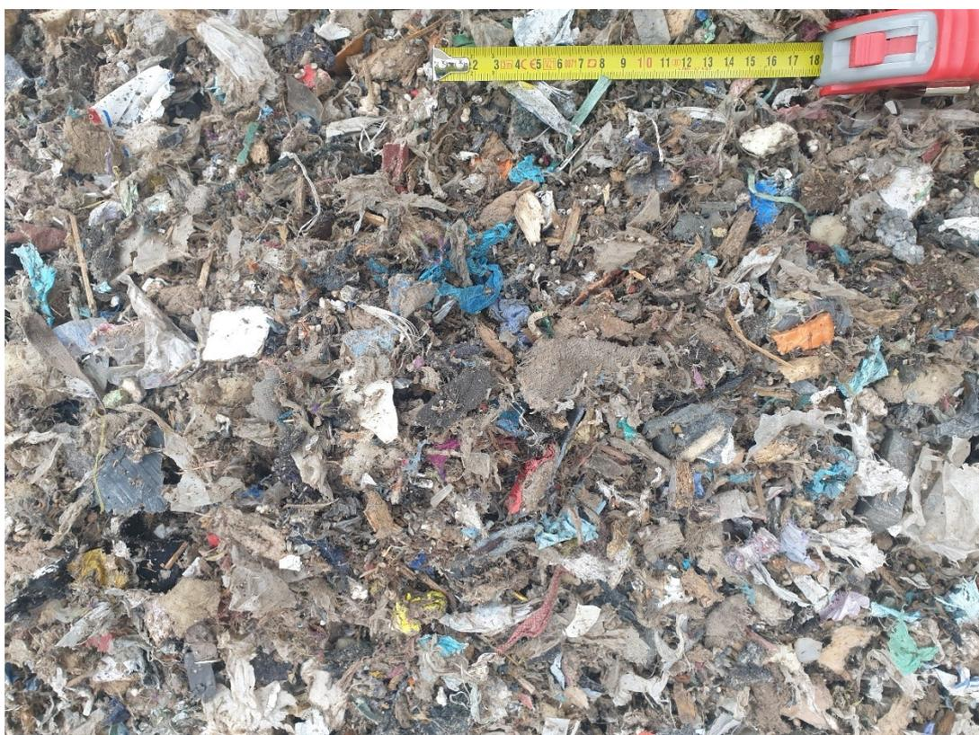
Abbildung 39: Ergebnis der Zerkleinerung durch den mobilen 1-Wellen-Zerkleinerer
