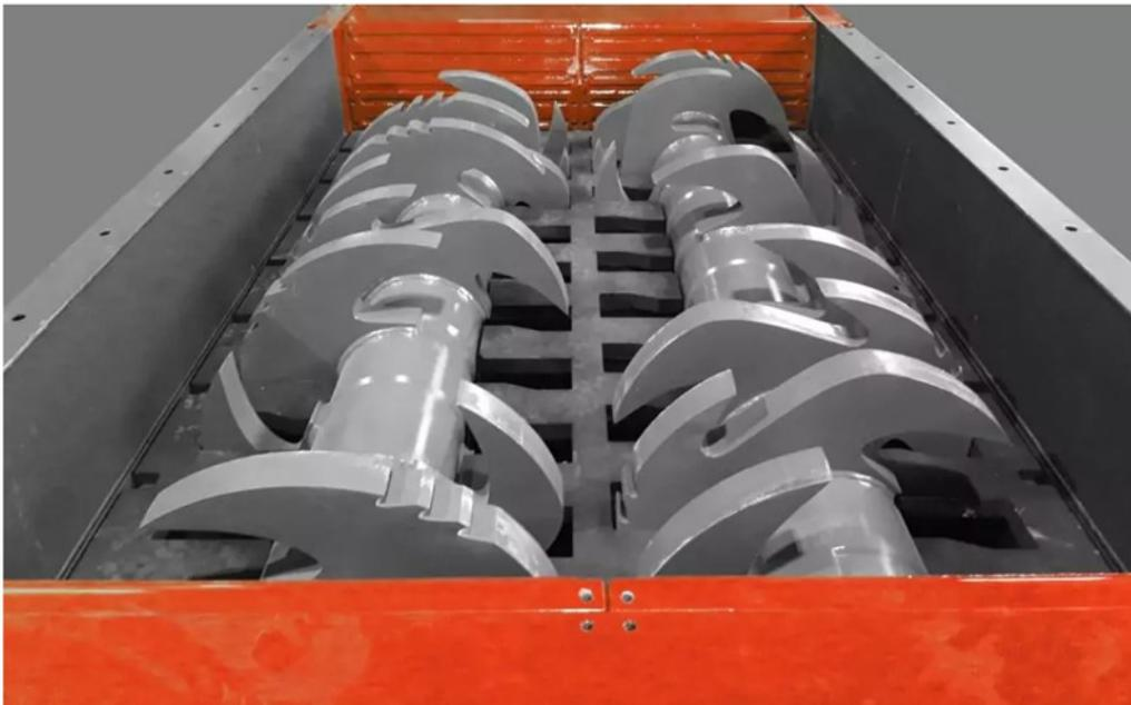
Abbildung 3: Mehr-Wellen-Zerkleinerer der Firma WEIMA Maschinenbau GmbH [12]
