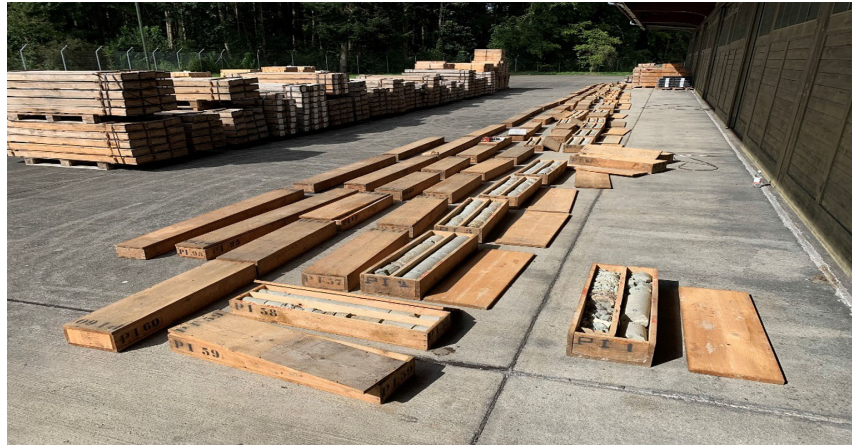
Abb. 5: Eine im Jahr 1944 durchgeführte Bohrung im FCC-Trassenbereich. Gesteinsproben in den 98 Kernboxen wurden geologisch (sedimentologisch), mineralogisch sowie geotechnisch und petrophysikalisch in Feldversuchen und Laboren untersucht
