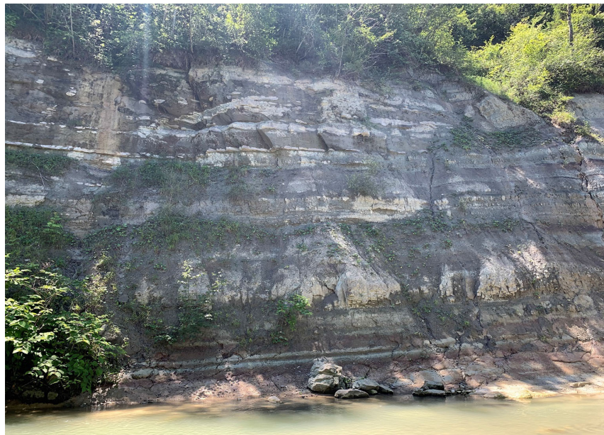
Abb. 6: Molasse-Aufschluss entlang der FCC-Trasse. Proben wurden aus dem Gesteinsverband entnommen und als vollständige Kerne oder als Plugs (kleine, zylinderförmige Proben) im Labor analysiert
