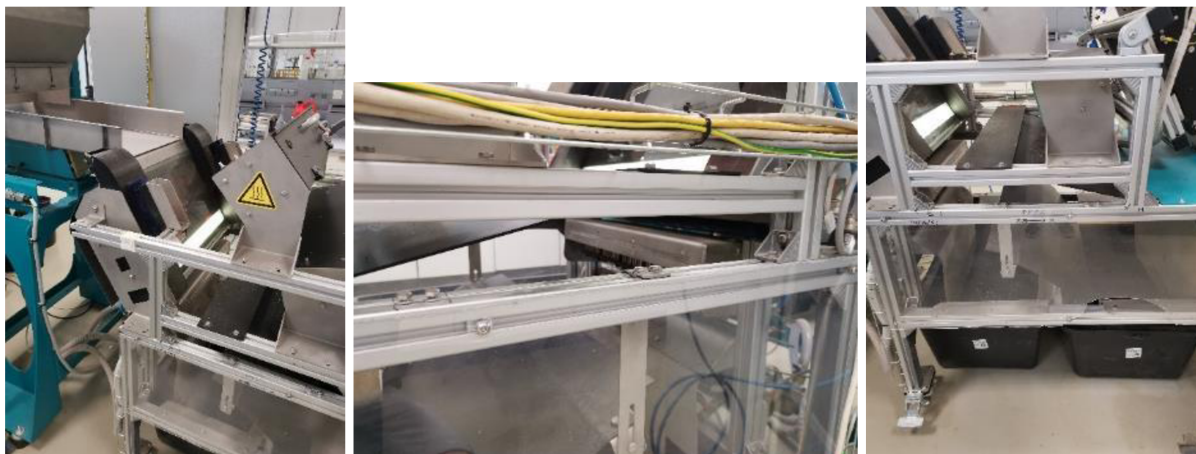
Abbildung 18: NIR-Sortierer, rechts: Probenbehälter mit Trennblech, Mitte: Düsenleiste, links: Aufgabetrichter mit Rüttelwanne und geneigter Detektorfläche, Quelle: Martin Berger
