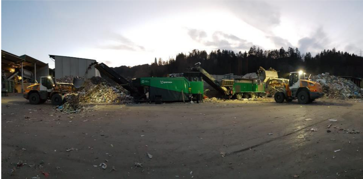
Abbildung 19: Versuchsaufbau bei der Firma Mayer Recycling; von rechts nach links: Aufgabe mit Radlader, Terminator, Multimeasure, Radlader für Probenahme, Quelle: Sandra Viczek
