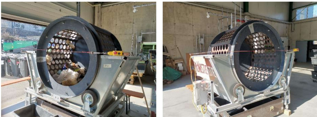
Abbildung 15: Trommelsieb mit austauschbaren Siebschnitten, Quelle: Martin Berger
