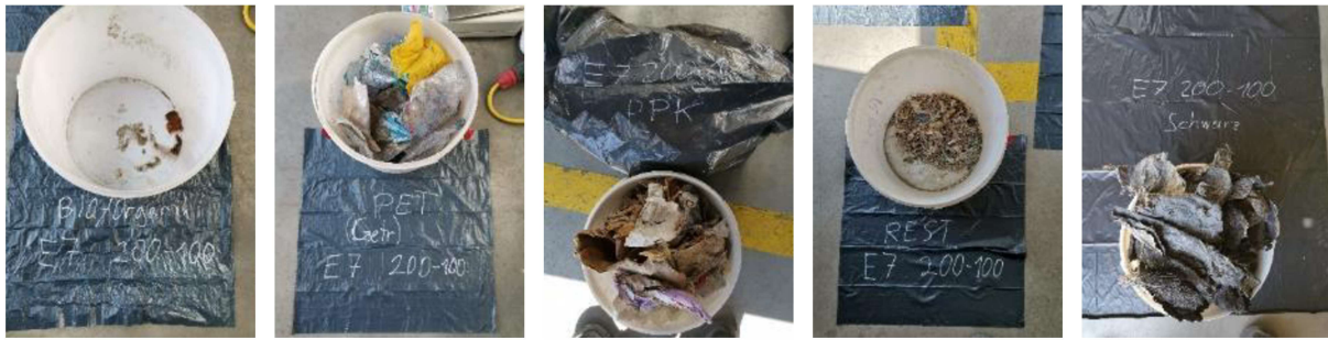
Abbildung 31: Aussortierte Fraktionen, von rechts nach links: Schwarz, Rest, PPK, PET (Getr.) und Organik, Quelle: Martin Berger
