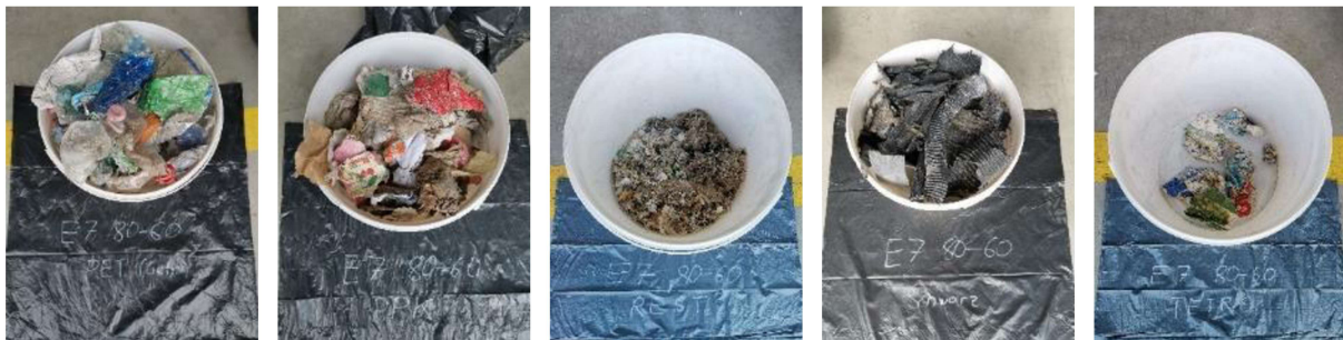
Abbildung 38: Aussortierte Fraktionen, von rechts nach links: Tetra, Schwarz, Rest, PPK und PET (Getr.), Quelle: Martin Berger
