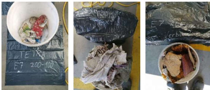
Abbildung 32: Aussortierte Fraktionen, von rechts nach links: Verbund, Textil und Tetra, Quelle: Martin Berger
