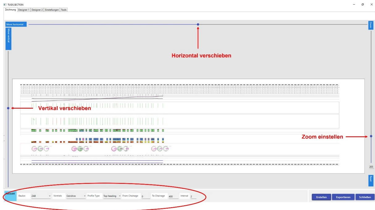
Abbildung 85: Automatisiert erzeugtes, baugeologisches Tunnelband in TUGIS.SECTION
