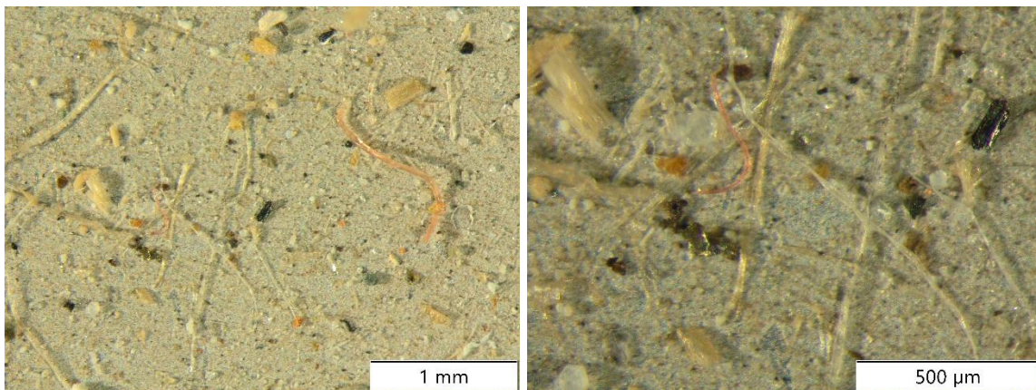
Abbildung 20: Mikroskopaufnahmen der Klärschlammprobe auf einem aluminiumbeschichteten Filter mit dem Auflicht-Stereomikroskop Olympus SZX12, Objektiv 1,6, Vergrößerung links 2,5x, rechts 3,2x;
