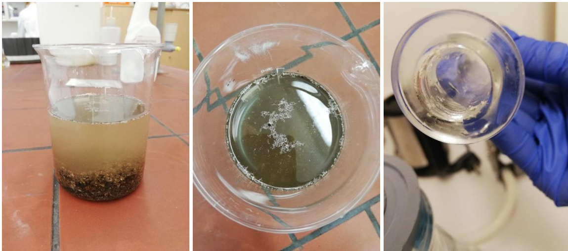
Abbildung 7: Dichteseparationsversuch von Polyethylen (< 0,5 mm) und getrocknetem Sandfangmaterial der Kläranlage Knittelfeld mit einer K_2CO_3 -Lösung (Bild 1 und 2) und der Mikroplastikrückstand nach der Filtration im Filtrationsrohr (Bild 3)
