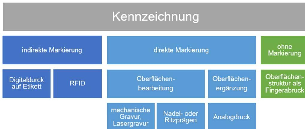
Abbildung 10: Methoden der Teilekennzeichnung<sup>111</sup>
