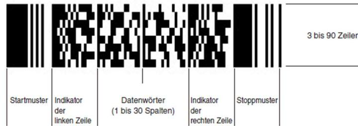
Abbildung 13: Aufbau eines PDF417-Codes<sup>134</sup>
