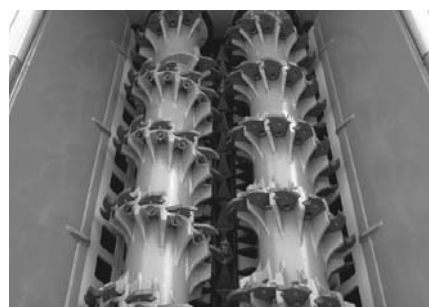
Bild 1: Blick in den Zerkleinerungsraum eines Zweiwellenzerkleinerers [1]
