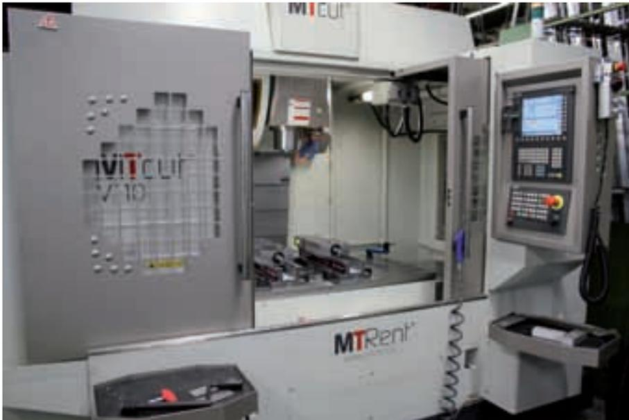
Das vertikale Bearbeitungszentrum MTcut V110TH ist leistungsfähig, langzeitgenau und – insbesondere mit dem Lehmann-Drehtisch – sehr flexibel einsetzbar
