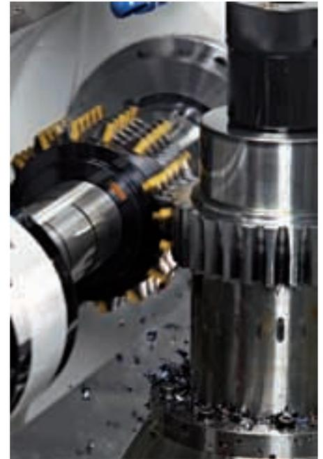
Die Fräser werden mit Standardwendepplatten zur Herstellung von Zahnprofilen nach DIN3972-2 ausgeliefert
