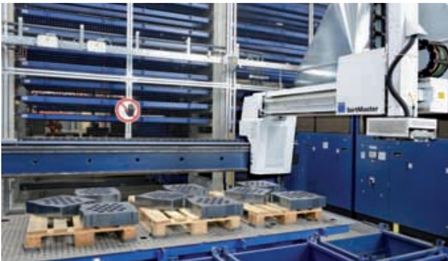
Die Laserschneidmaschine TruLaser 3030 ist mit dem automatischen Vereinzelungssystem SortMaster ausgestattet
