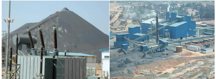
**Abb. 17** Der „Big Hill“ von Lubumbashi in Katanga (Demokratische Republik Kongo). Die Halde mit 15 Millionen Tonnen Inhalt ist eine potenzielle Germaniumquelle. Die Schlacken aus der Kupfer- und Zinkproduktion stammen aus der Verhüttung Ge-reicher Sulfiderze (z.B. der Lagerstätte Kipushi). Sie werden seit über 10 Jahren zur Gewinnung von Kobalt, Zink und Kupfer in der Fabrik der GTL (Groupement de Terril de Lubumbashi; rechtes Bild) genutzt.
