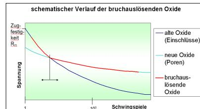
Das Diagramm zeigt den schematischen Verlauf der bruchauslösenden Oxide bei varierender Spannung und Schwingspielen.
