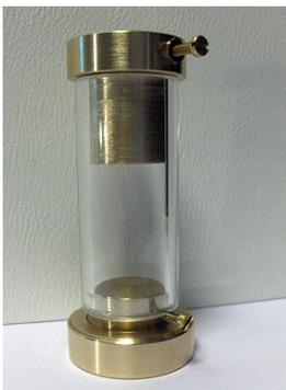
Abb. 2: Eine der verwendeten Messzellen zur Untersuchung der spezifischen Leitfähigkeit eines Körnerpräparates
