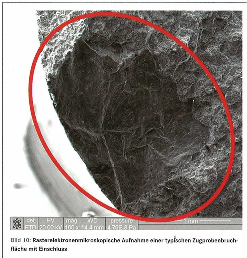
Bild 10: Rasterelektronenmikroskopische Aufnahme einer typischen Zugprobenbruchfläche mit Einschluss
